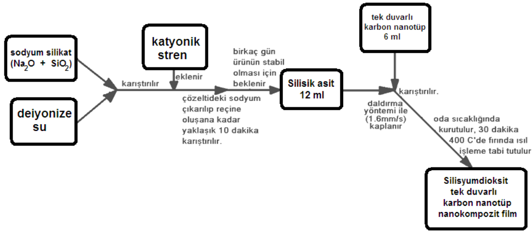
Şekil 4.10 : Silisyumdioksit nanotüplerin karbon nanotüpler kullanılarak eldesi.
