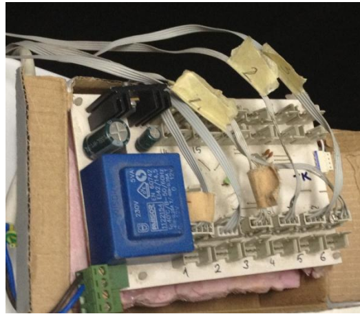
Şekil 4.9 : Nem sensörleri için elektronik kart.
