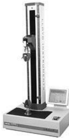
Şekil 2.5. Çalışma kapsamında kullanılan Lloyd Instruments LRX Plus marka çekme cihazının genel görünümü
