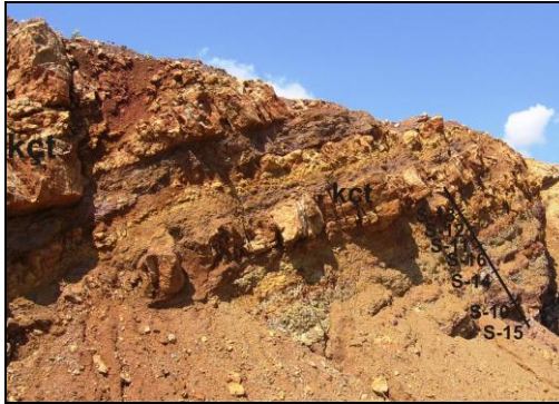
Şekil 4.21. İnceme anındaki Fe ve al lateritlerden yer yer yatay yer yer düşey numune alımı
