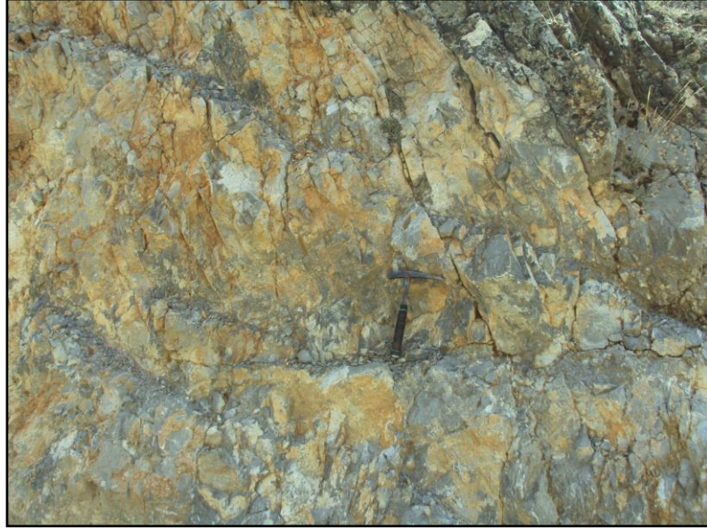
Şekil 4.19. Hacıalabaz formasyonuna ait kireçtaşlarının kırık ve çatlaklı görünüşü
