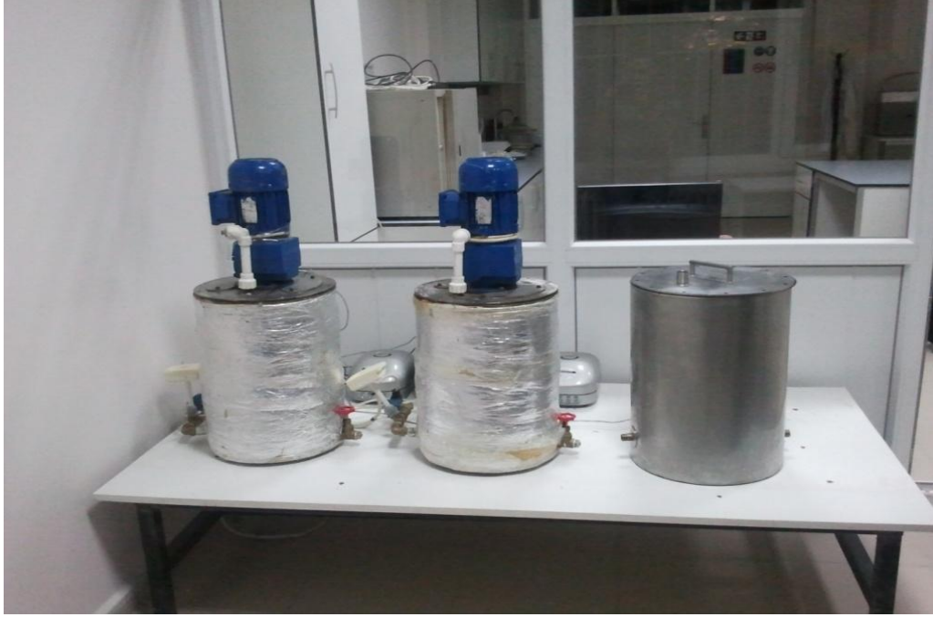
Şekil 3.2 Deneyde kullanılan kesikli aerobik kompost reaktörlerin görünümü
