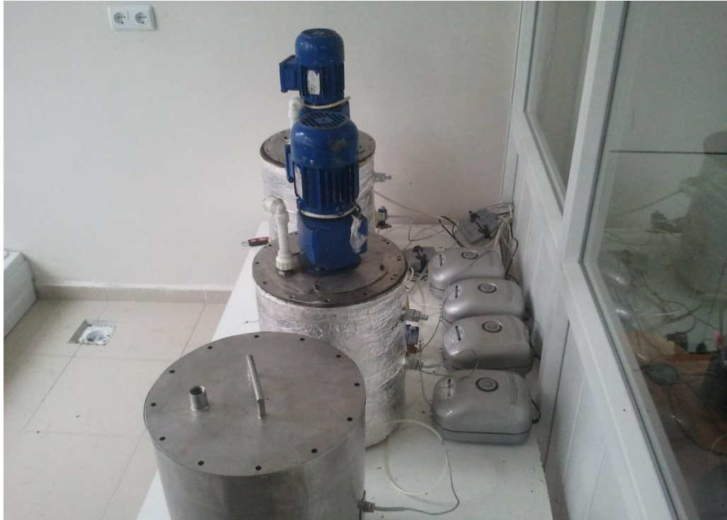
Şekil 3.3 Deneyde kullanılan kesikli aerobik reaktörler ve akvaryum pompaları
