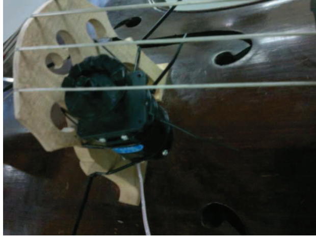
Resim 29: Köprüye sabitlenen elektrikli motor (a)
