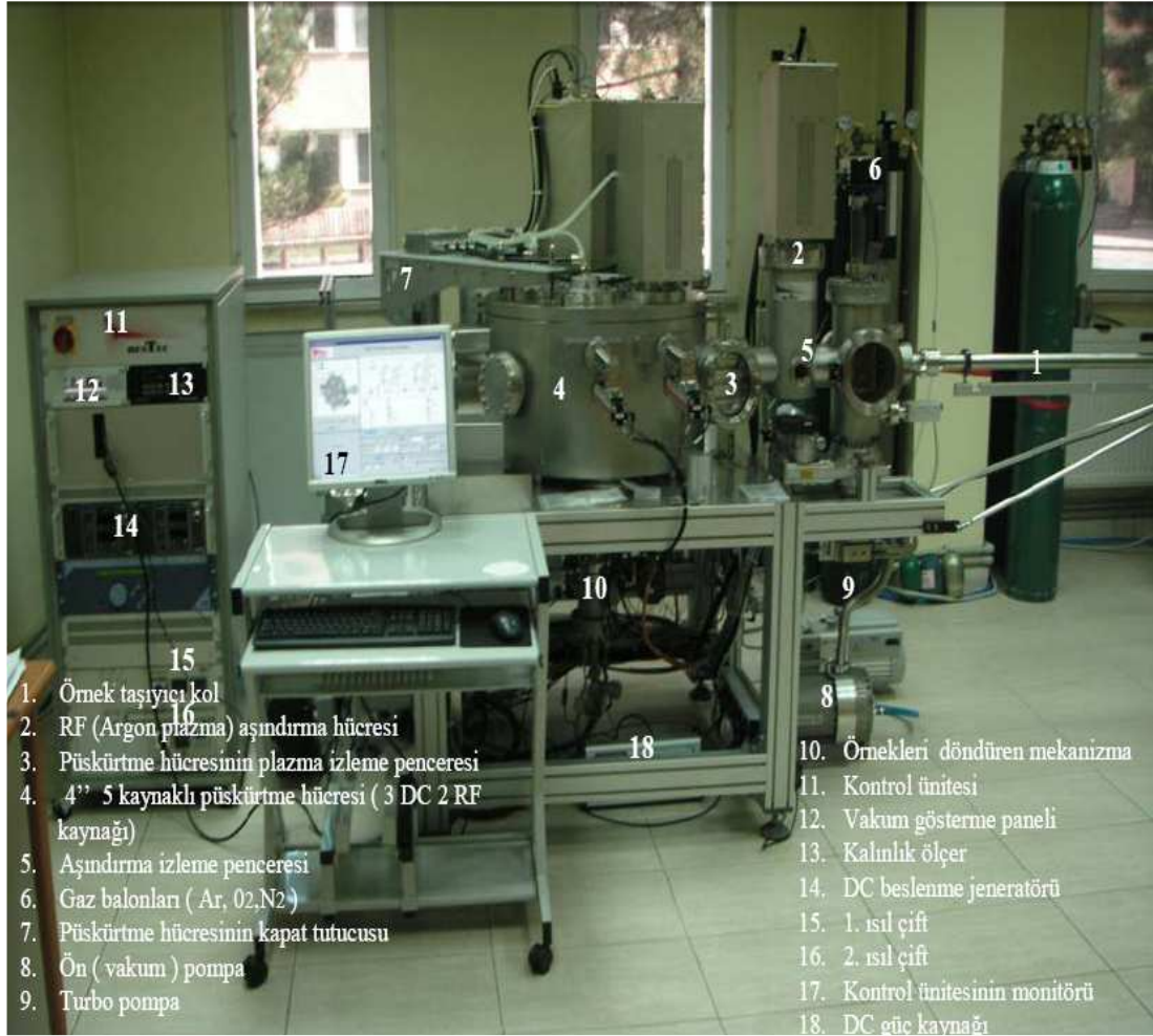
Resim 3.1. BESTEC firmasından alınan 3'' ultra yüksek vakuma sahip püskürtme sistemi
