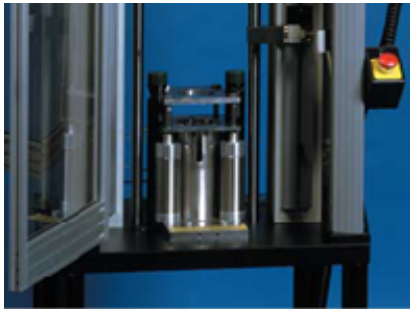
Resim 6.13. Pnömatik test fikstürü [28]
