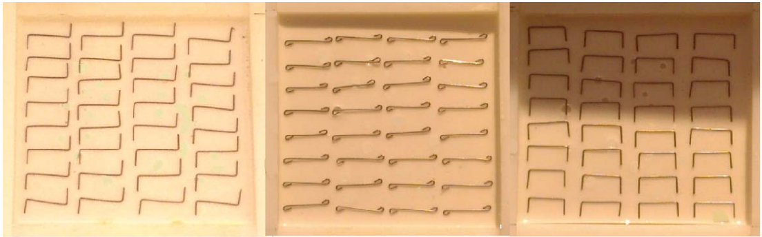
Resim 6.1. Fiberlerin kalıplara dökülen matris üzerine dizilimi
