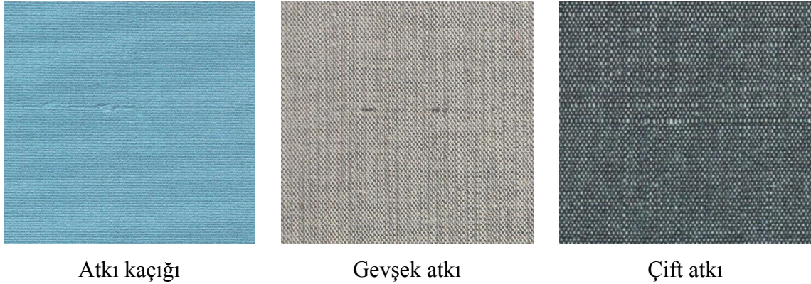
Şekil 1.2. Atkı yönündeki hatalar
