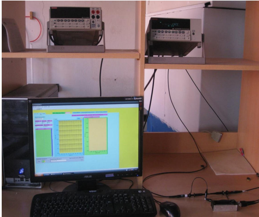
Şekil 3.7. I - V ölçüm sisteminin fotoğrafı
