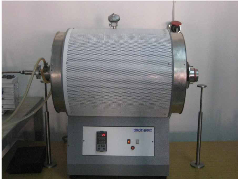
Şekil 3.3. Tavlamanın gerçekleştirildiği yüksek sıcaklık fırını
