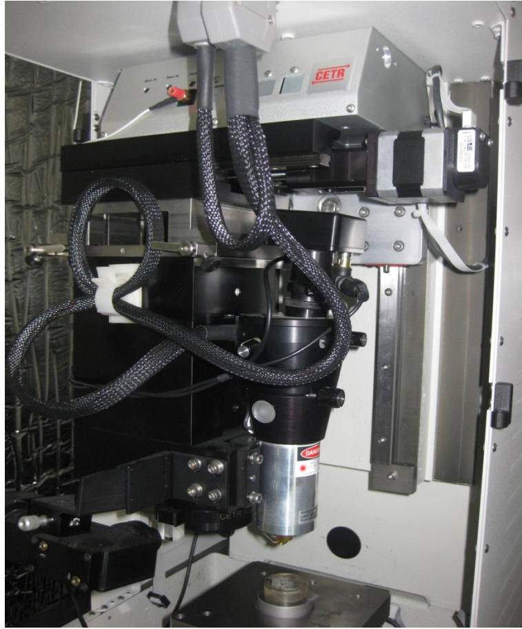
Şekil 3.8. Nanoçentme deneylerinde kullanılan atomik kuvvet mikroskobu ileştirilmiş nanoçentme cihazı
