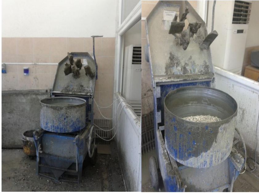
Şekil 3.2. Çalışmalarda kullanılan beton mikseri
