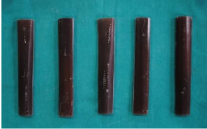
Resim 20: 4. kuşak sentetik femurlardan elde edilen 2.5 cm x 15 cm boyutlarındaki strut allogreftler
