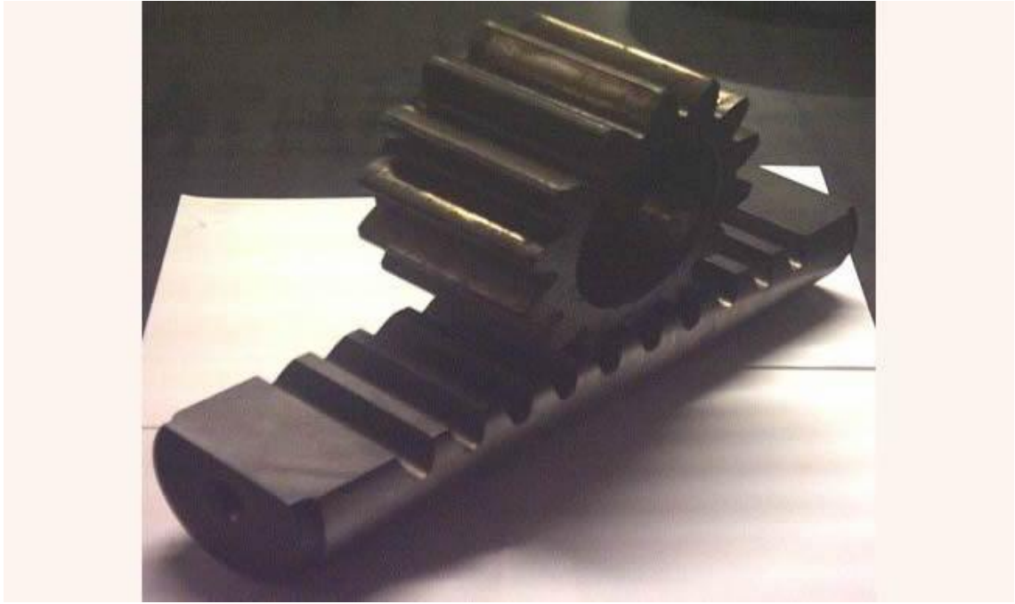
Şekil 5.2. Kremayer dişli sistemi örneği.
