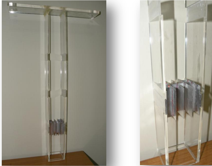
Şekil 8 Yakıt ayırıcısının, yakıt ayırıcı tutma aparatına yerleştirilmiş hali.
