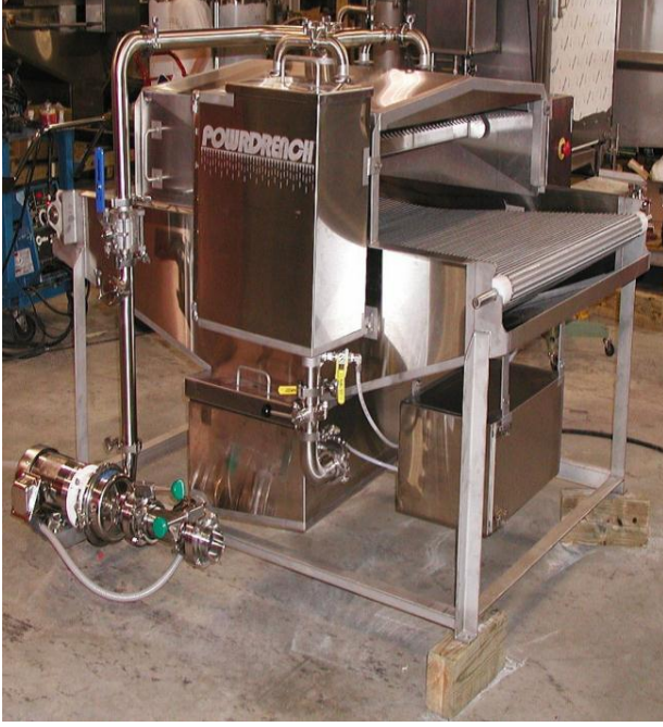
Şekil 2.6. Sıvı Tütsünün Peynir Yüzeyine Sürekli veya Islatma Sistemi ile Uygulanması (Wendorf, 2010)
