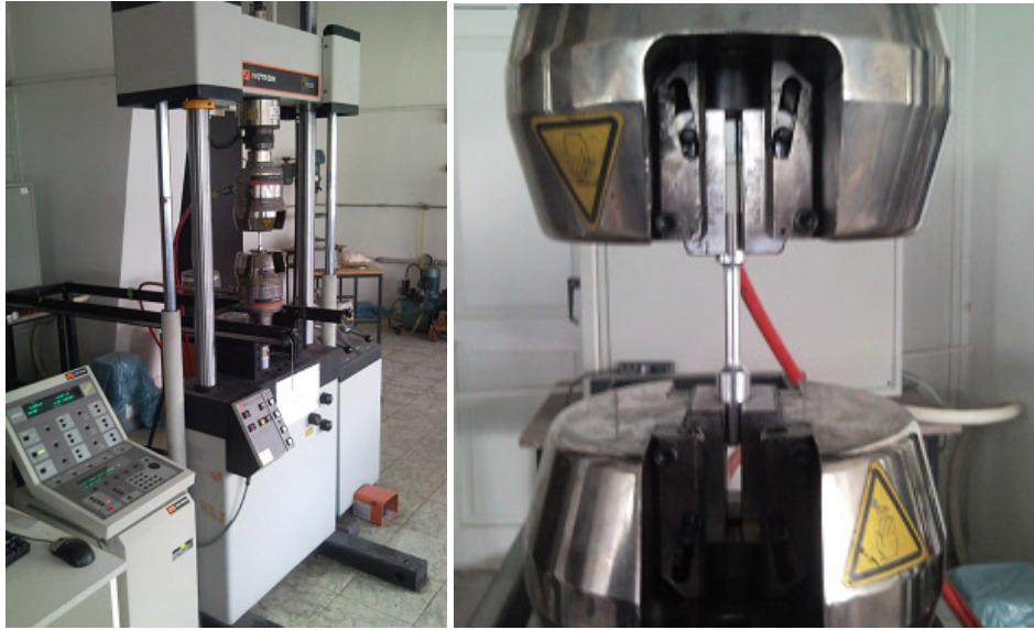
Şekil 4.4. Yorulma deneylerinin yapıldığı INSTRON 8501 dinamik test cihazı.
