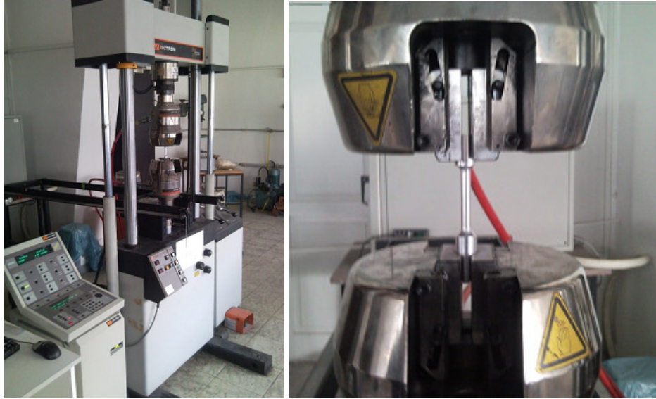
Şekil 4.13. Yorulma deneylerinin yapıldığı INSTRON 8501 dinamik test cihazı.
