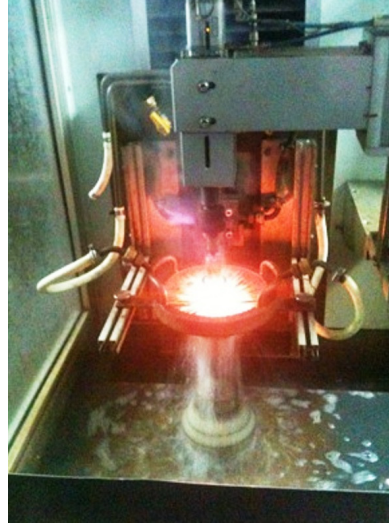
Şekil 4.12. İndüksiyonla yüzey sertleştirme işlemi test cihazı uygulama örneği.
