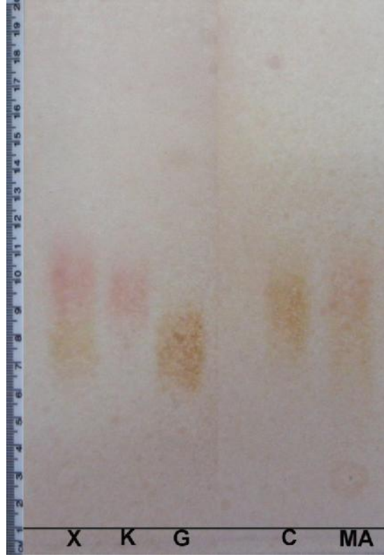
Şekil 4.43. Belirlenen optimal koşullarda hidrolize tabii tutulan substrattan elde edilen ürünlerin ince tabaka kromatografisinde görüntülenmesi. X hattı görüntülenmek istenen örnek; K hattı ksiloz standartını, G hattı glukoz standartını, C hattı sellobiyoz standartını, MA hattı mannoz ve arabinoz standartını ifade etmektedir. Kromatogram üzerinde pembe lekeli yerler pentozları, kahverengi lekeli bölgeler ise heksozları göstermektedir.
