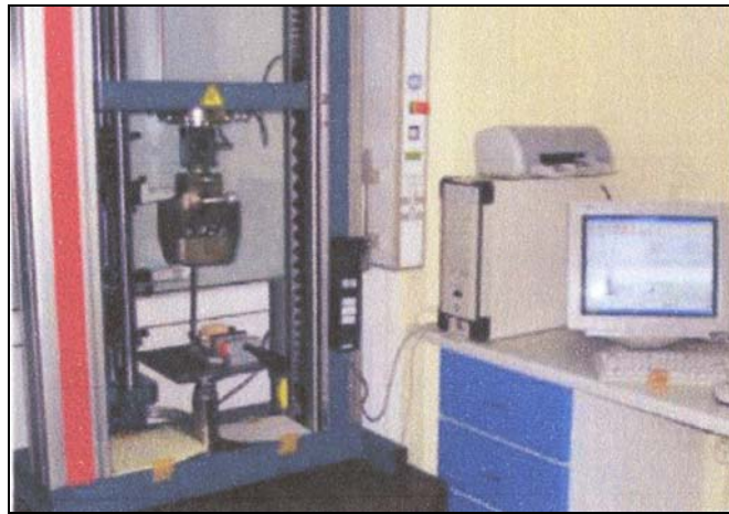
Resim 2.6. Makaslama testinin uygulandığı düzenek
