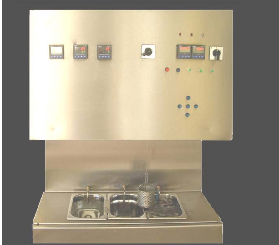
Resim 2.2. Termal siklus cihazı (E.Ü. Dişhekimliği Fakültesi, İzmir)
