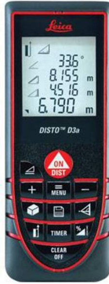
Şekil 3.2. Araştırmada kullanılan lazermetre cihazı
