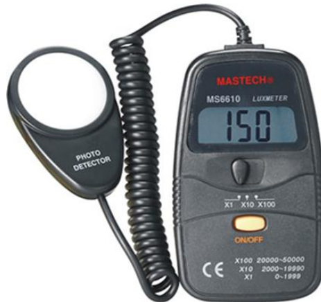
Şekil 3.3. Araştırmada kullanılan lüksmetre cihazı.
