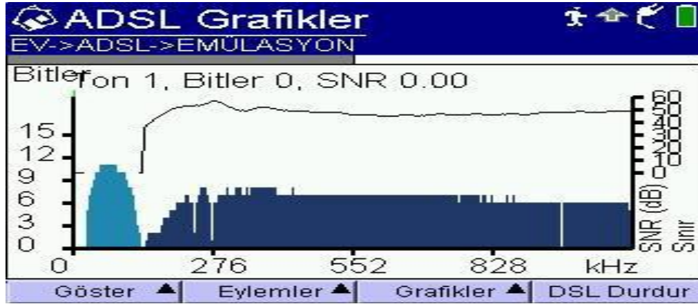
Şekil 7.2. ADSL devresinin bant genişliği ölçümünün HST 3000 C cihazındaki gösterimi
