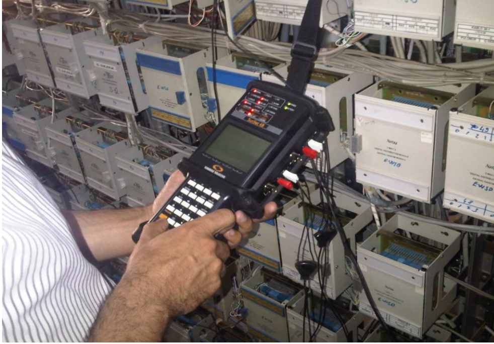
Resim 10.1. Bakır devre bant geniřlięi lm cihazı ve dzeneęi
