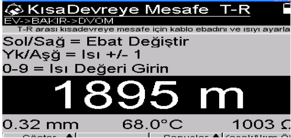
Şekil 7.3. Mesafe ölçüm sonucunun HST 3000 C cihazındaki görünümü
