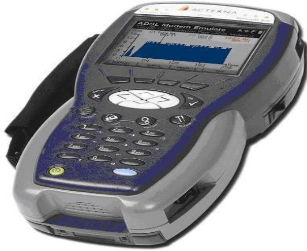
Resim 7.1. ACTERNA HST 3000 C ölçüm cihazı
