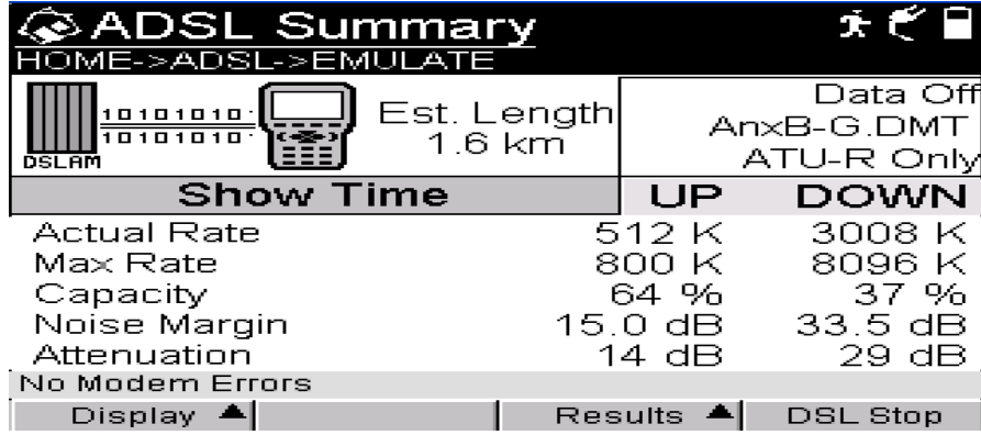
Şekil 7.1. ADSL ölçüm sonuçlarının HST 3000 C cihazındaki gösterimi
