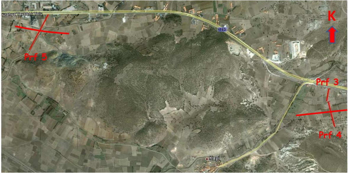
Şekil 6.35. Profil 3,4 ve 5 GPR ölçümlerinden tespit edilen gömülü fayların olası yerlerinin yakından görünümü.
