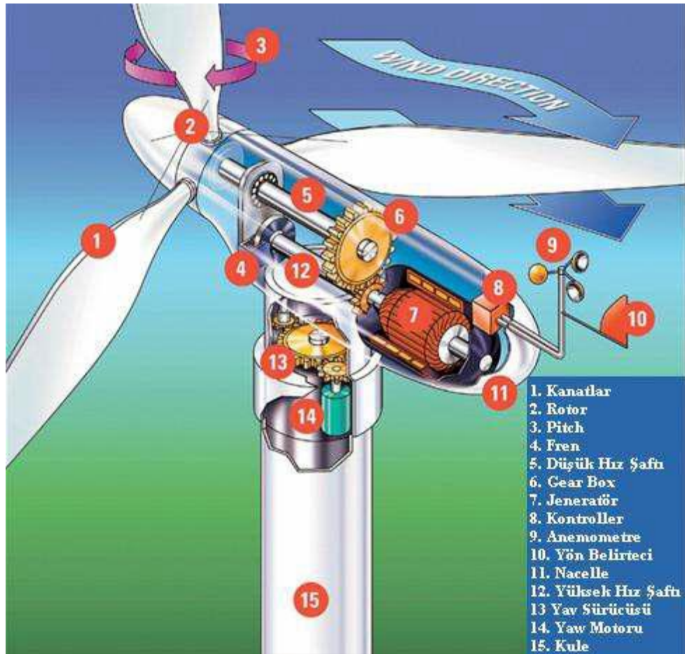
Şekil 3.9. Rüzgâr Türbin Elemanları ( Anonim, 2006a)
