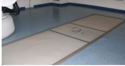
Şekil 3.1.3. CyberKnife® Robotik Radyocerrahi Sistemine Ait Amorf Silikon Dedektörlerin Genel Görüntüsü
