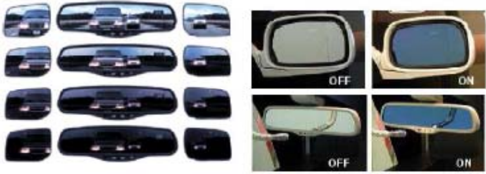
Şekil 2.16. Elektrokromik arka görüş aynalarının karaması
