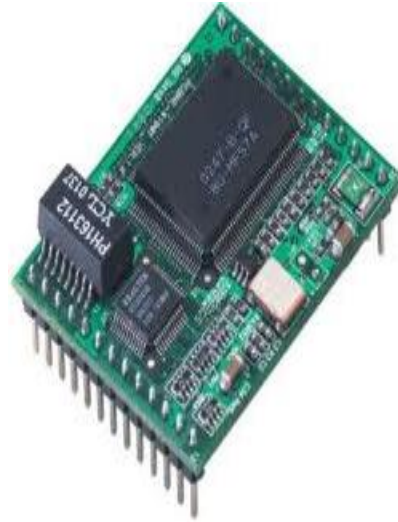
Şekil 3.26. NE 4100T ethernet modülü ve ayak bağlantıları
