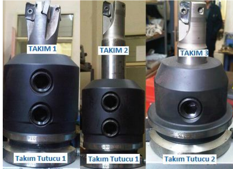
Şekil 3.2. Denemelerde kullanılan kesici takım ve takım tutucular
