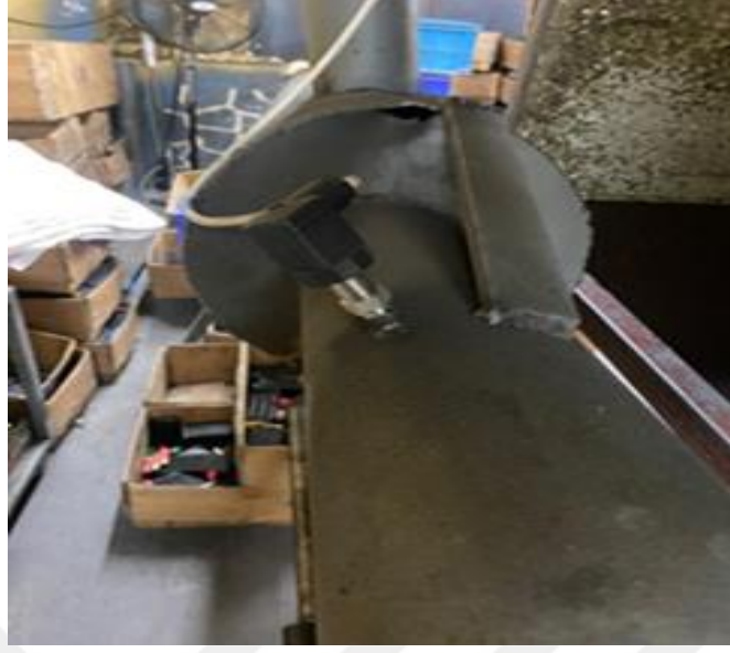
Resim 5.1: Basınç sensörünün atış ünitesine montajı
