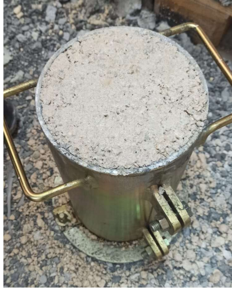
Şekil 3.8 : 4 Katman yerleştirip sıkıştırılması tamamlanmış numune.
