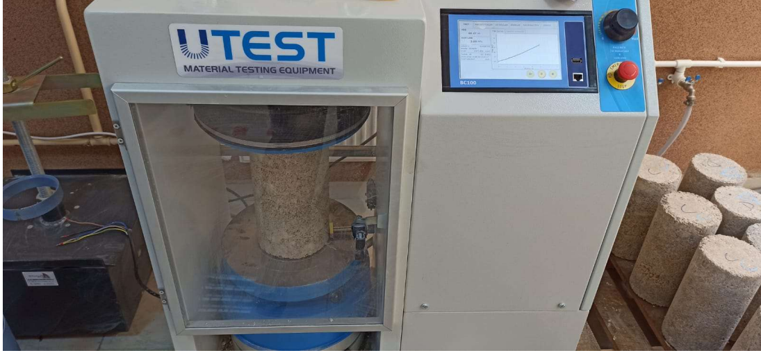
Şekil 3.11 : Basınç testi yapılan plastik katkılı numune.
