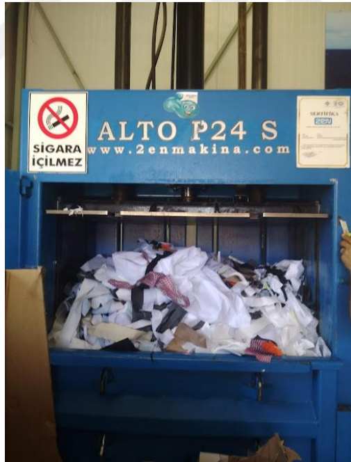
Şekil 186- Çalışma 1’de Kullanılan Balyalama Tekniği; Malzemelerin Sıkıştırılması Aşaması. İzmir Hugo Boss Firması Atık Bölümü,
