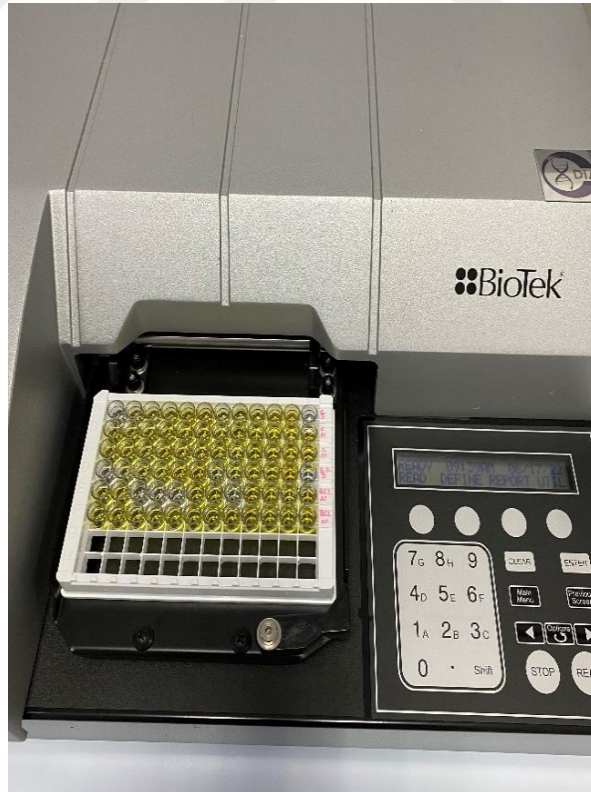
Şekil 3.11 Mikroplaka okuyucuda absorbans ölçümü
