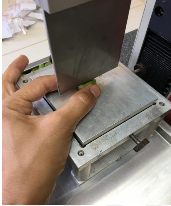
Resim 3.14. Üniversal test cihazında kesme denemeleri
