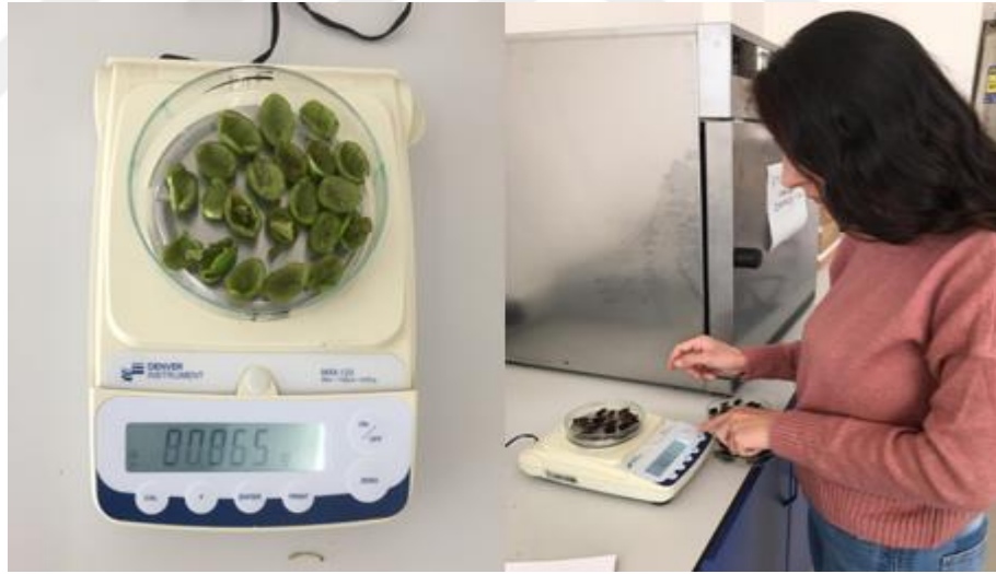
Resim 3.8. Zeytin meyvesi nem içeriğinin belirlenmesi
