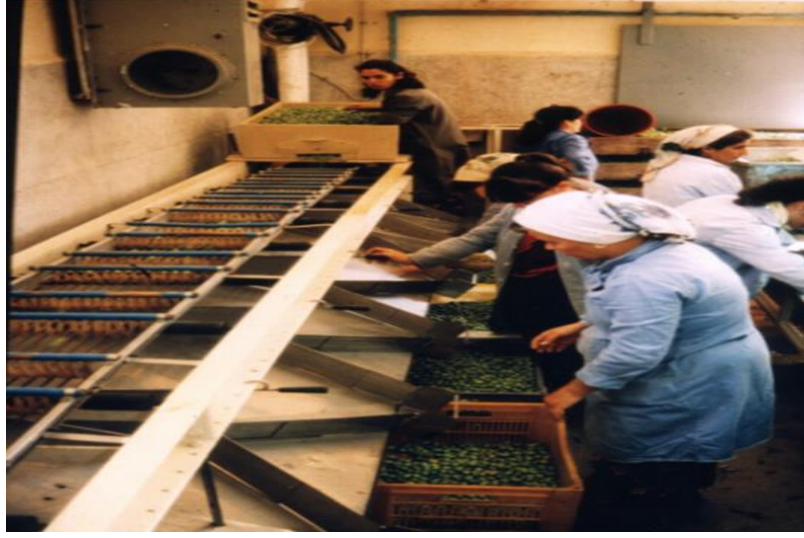
Resim 1.1. Boylama ve ayıklama işlemi (Kıvrak, 2015)
