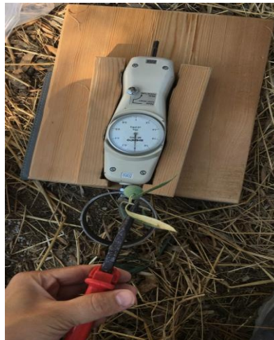
Resim 3.11. Tutunma kuvvetinin belirlenmesi
