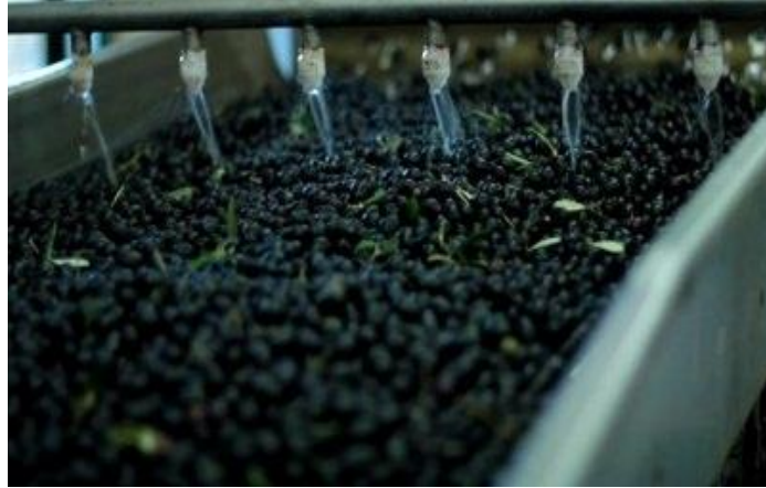
Resim 1.2. Zeytinlerin yıkanması işlemi (Anonim, 2019b)
