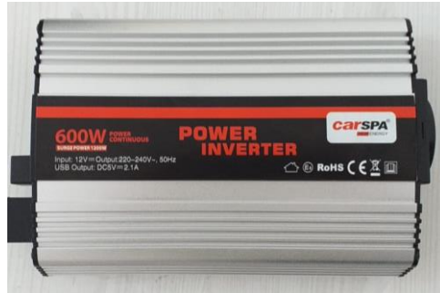
Şekil 3.8. Sistemde kullanılan inverter ünitesi
