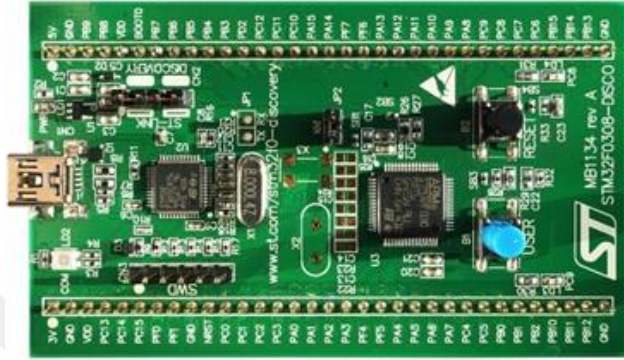
Şekil 3.3. STM32F0308 Discovery mikrodnetleyici ünitesi
