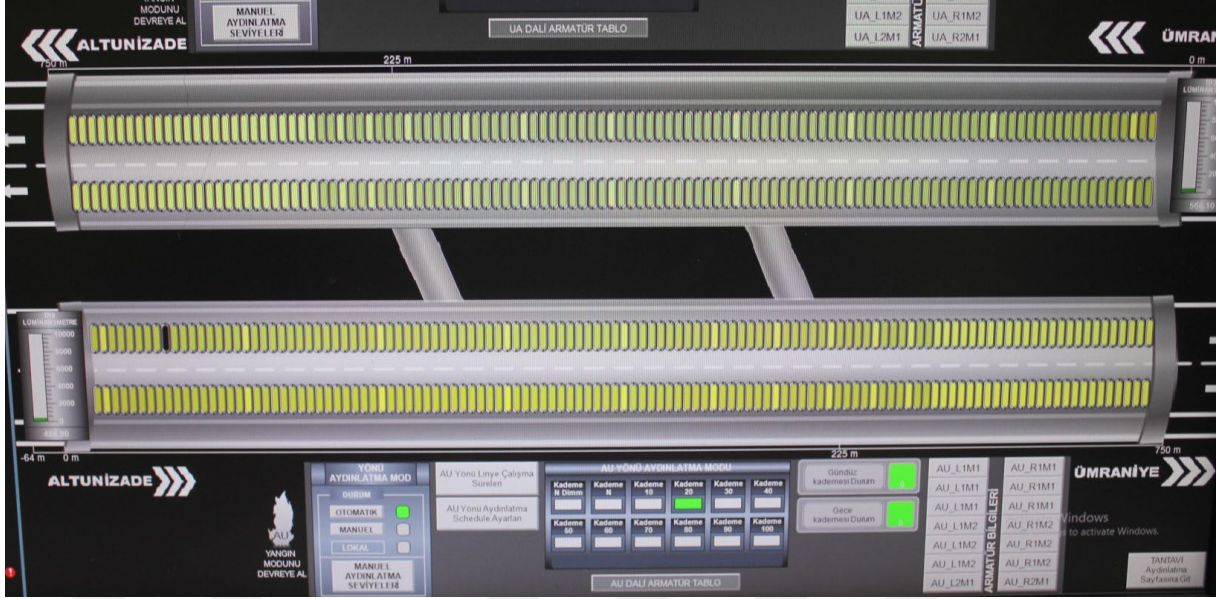
Şekil 3.10: Tüneldeki Aydınlatmaların SCADA Ekranındaki Gösterimi.
