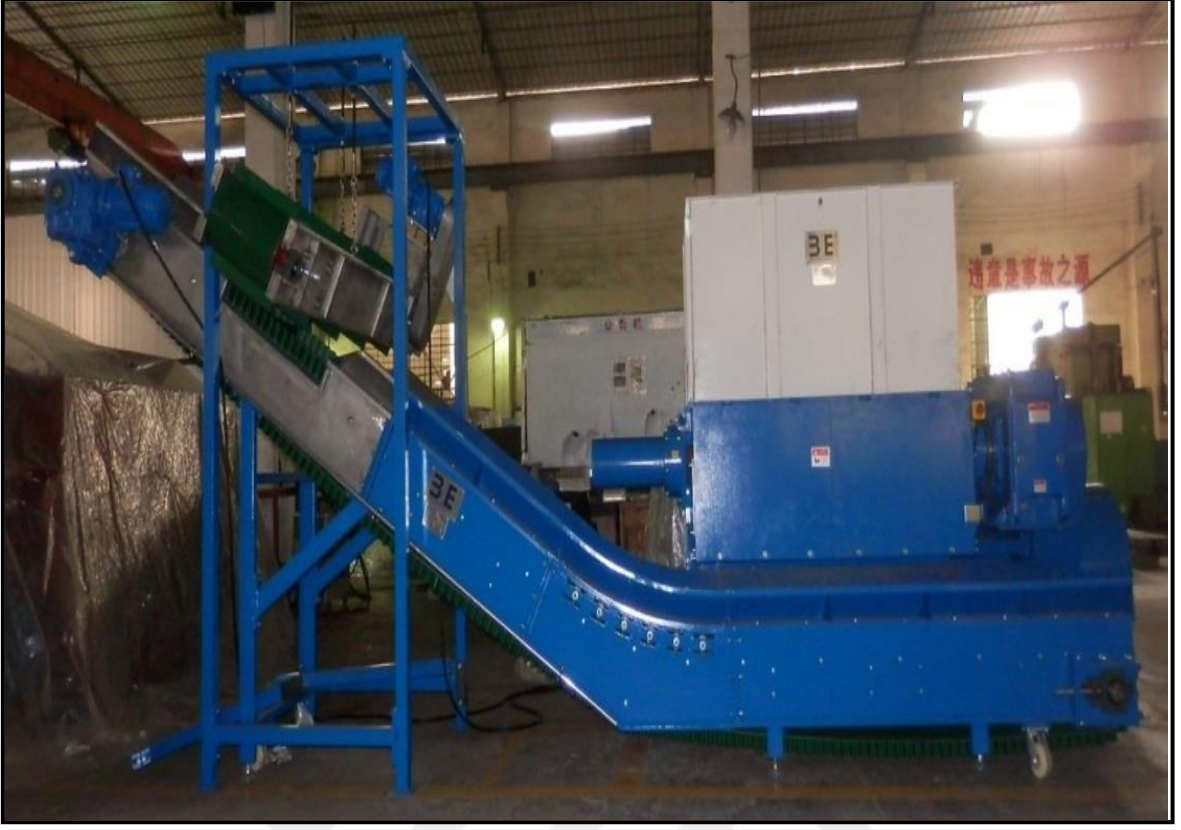
Şekil 4.11: Manyetik Separatörlü Kırıcı
