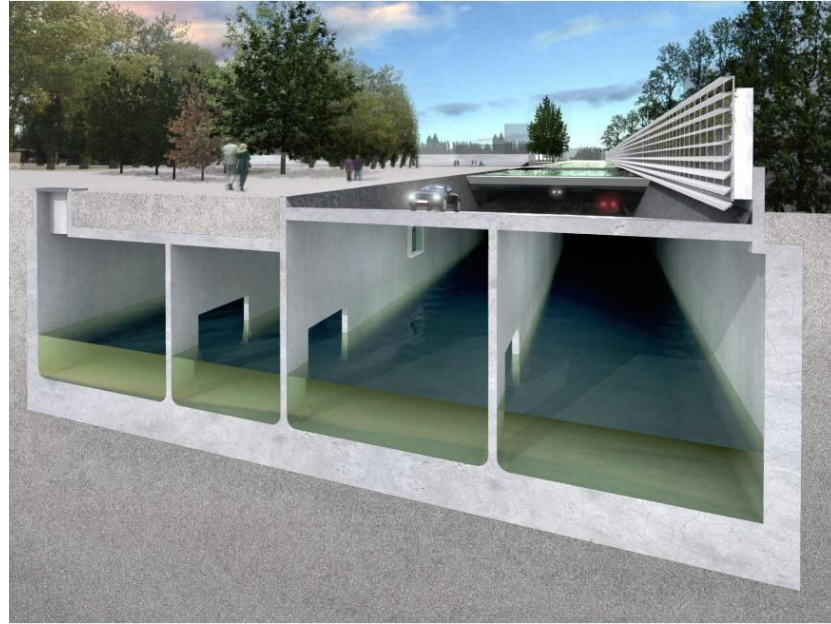
Şekil 2.33 : Otopark altı sarnıç kullanımı (The Atlas Community Team, 2011).
