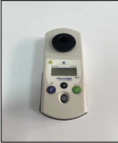
Şekil 11: DensiCHEK plus cihazı (mikroorganizma yoğunluğu ölçüm cihazı)
