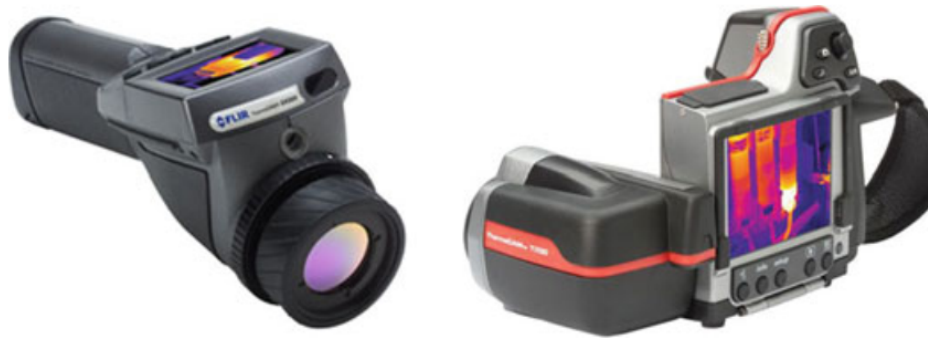
Şekil 2.14 : Termal kamera örnekleri (Tuğla ve diğ., 2018).
