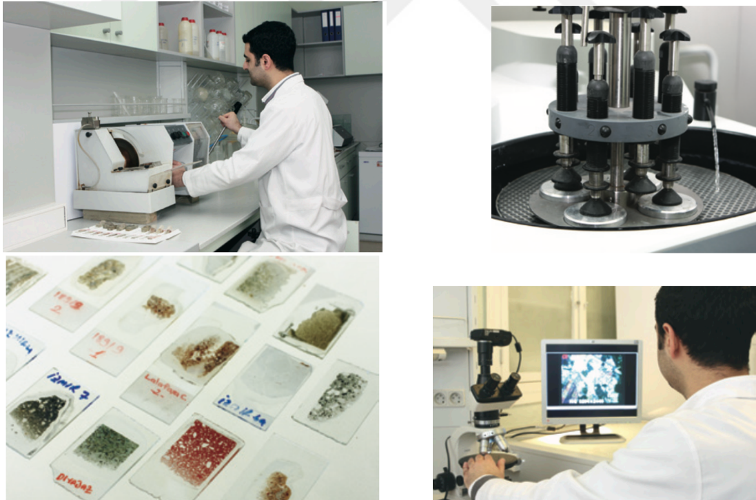
Şekil 2.26 : Sırası ile petrografi analizi için numunelerden ince kesitlerin hazırlanması, parlatılması, ince kesitlerin hazır hali ve mikroskop ile incelenmesi (KUDEP, 2011).
