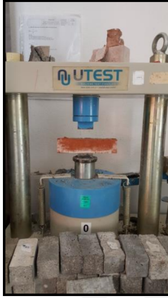
Şekil 2.25 : Tuğla numunelere uygulanan eğilmede çekme dayanım deneyi (Çağlar, 2018).
