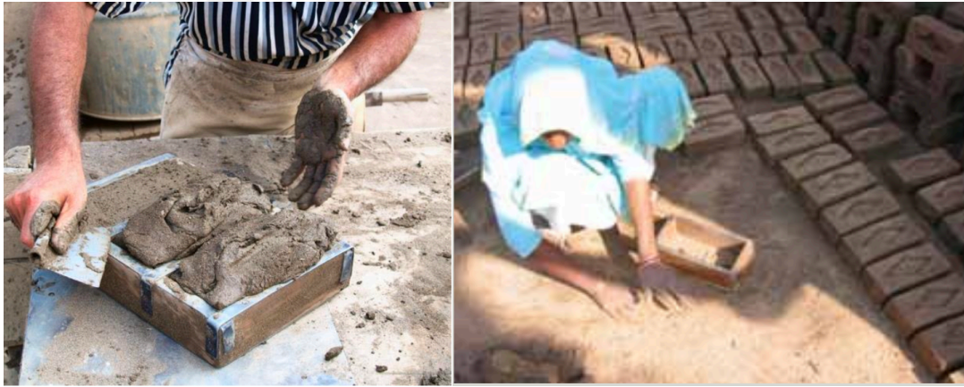
Şekil 2.6 : Kil hamurunun şekillendirilmesi (Er, 2013; Dick, 2020).
