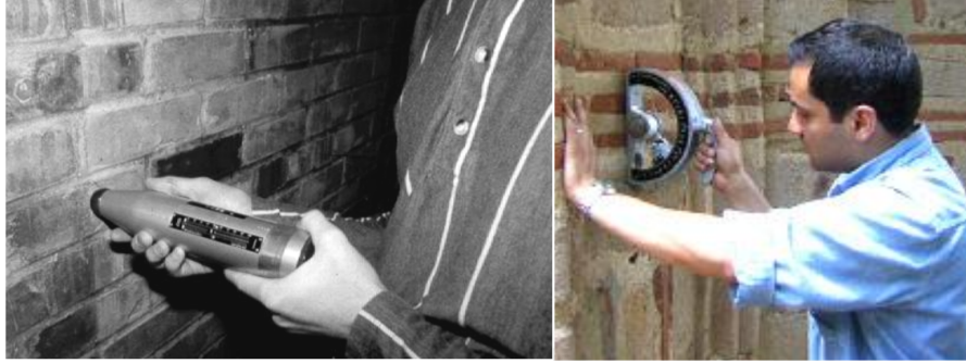
Şekil 2.11 : N tipi geri tepme çekici (solda), p tipi geri tepme çekici (sağda) (Schmidt Çekici) (Schuller, 2003; Arpacı, 2016).
