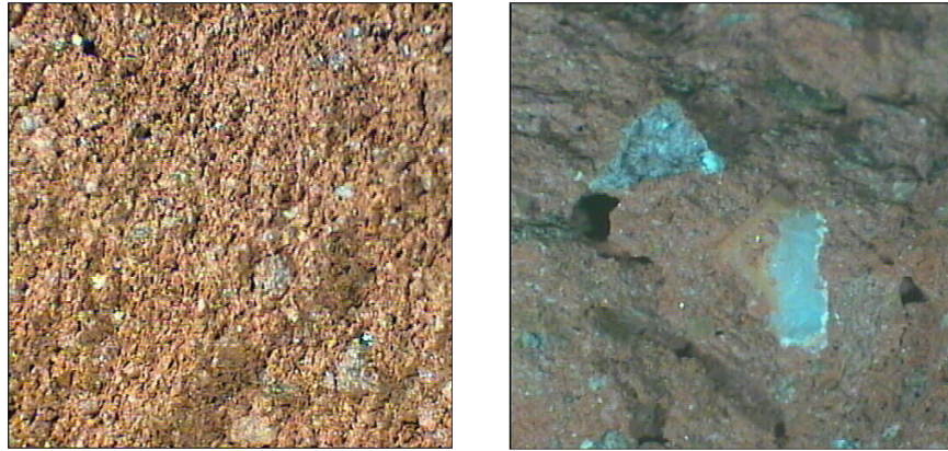
Şekil 2.9 : Tuğla malzemedeki farklı boyut ve oranlardaki gözenekler (Stefanidou, 2007).
