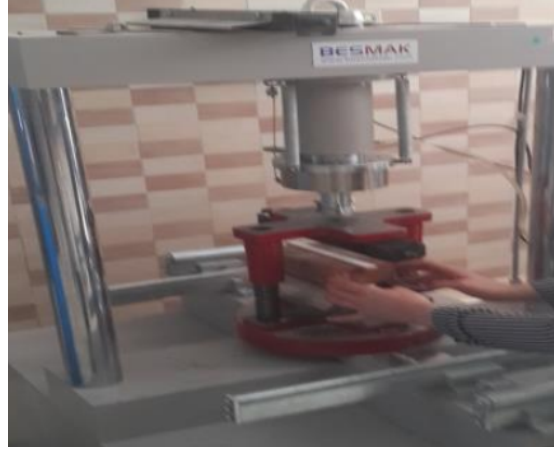
Şekil 2.24 : Tuğla numuneler uygulanan basınç dayanım deneyi (Çağlar, 2018).
