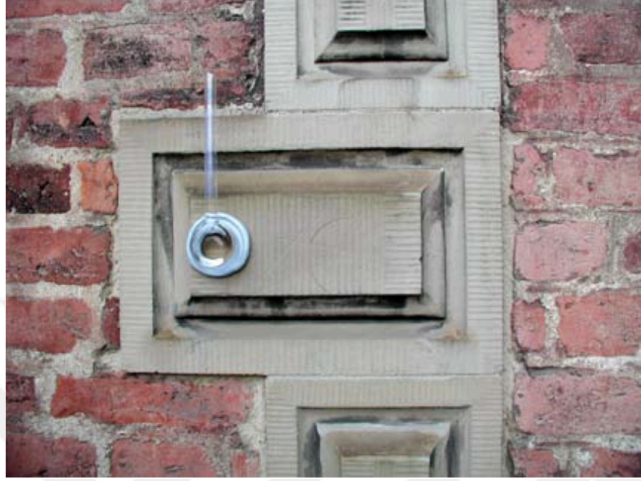
Şekil 2.17 : Karsten tüpü ölçümü (Svahn, 2006).
