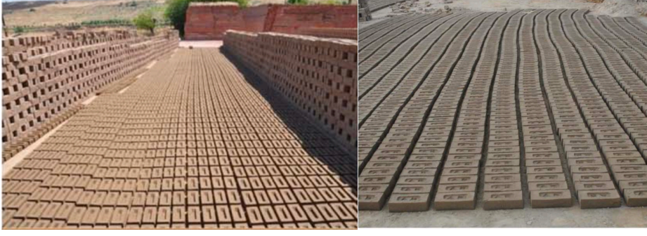
Şekil 2.7 : Şekillendirilmiş kil hamurunun güneşte kurutulması (Dalkılıç ve Nabikoğlu, 2017; Kazmi ve diğ, 2017).
