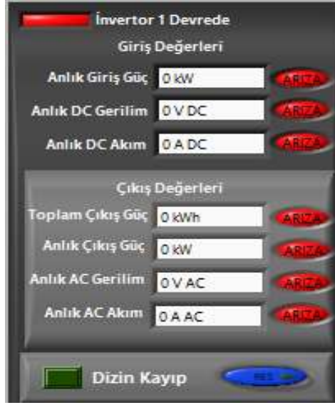
Şekil 3. 17. İnvertör 1 cihazının anlık değer izleme arayüz görüntüsü
