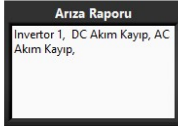
Şekil 4. 14. İnvörtör DC panosunun arıza durumdaki arıza raporu
