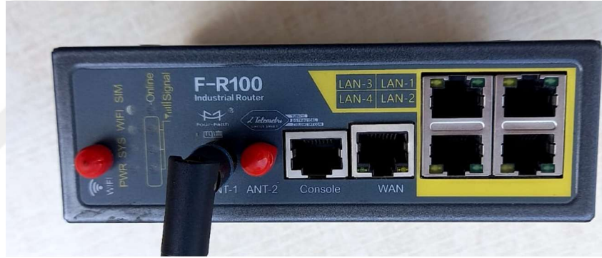
Şekil 3. 9. Four Faith F-R100 marka Router cihazı
