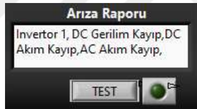
Şekil 3. 22. Olası arıza durumları için arıza raporu görünümü
