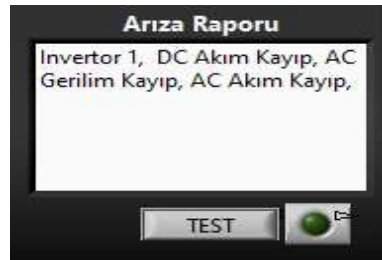
Şekil 4. 24. İnvertörün bağlı olduğu AC şalterin arıza durumdaki arıza raporu
