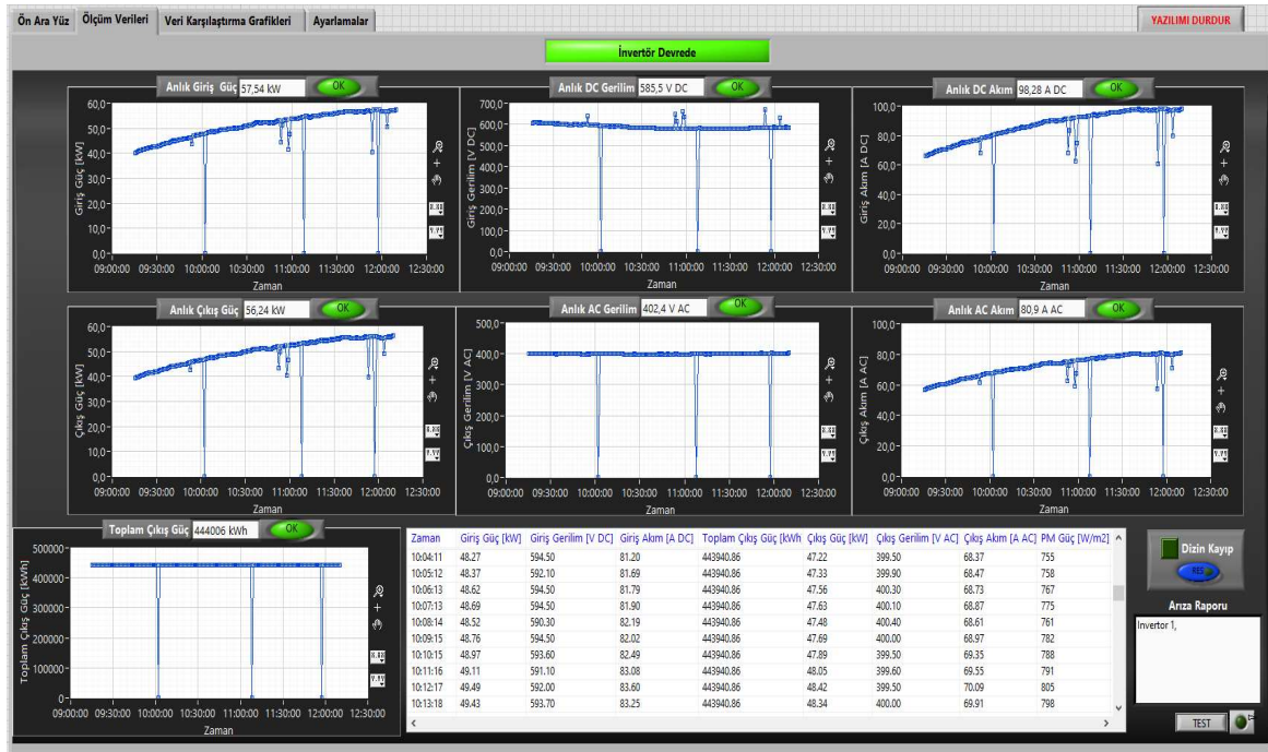
Şekil 4. 4. Invertor1 cihazının grafik ve değer izleme sayfası grafikleri ve ölçüm değerleri
