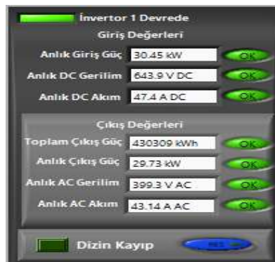
Şekil 4. 2. İnvertör 1 cihazının, LabVIEW programında eş zamanlı değer izleme arayüz görüntüsü.
