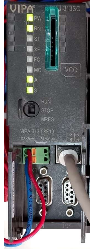
Şekil 3. 10. VIPA 313-5BF13 PLC cihazı
