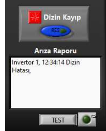
Şekil 3. 29. Dizin hatası raporu görünümü
