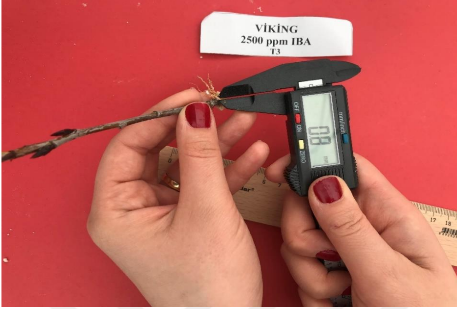
Şekil 4. 10. Köklenme görülen çeliğin kök kalınlığı ölçüsü
