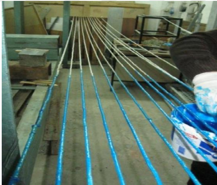
Şekil 2.28. CFRP çubukların uygulamaya hazırlanması (Pehlivan, 2019)
