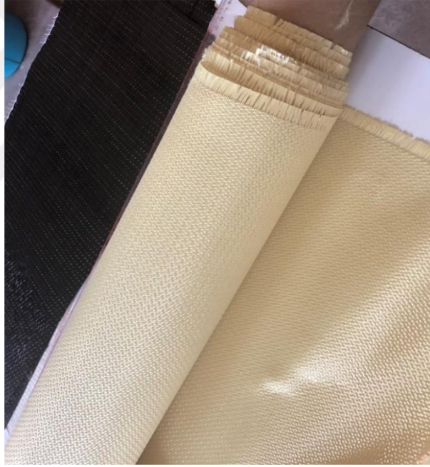
Şekil 2.11. Aramid fiber takviyeli kumaş örneği (Şenol, 2019)
