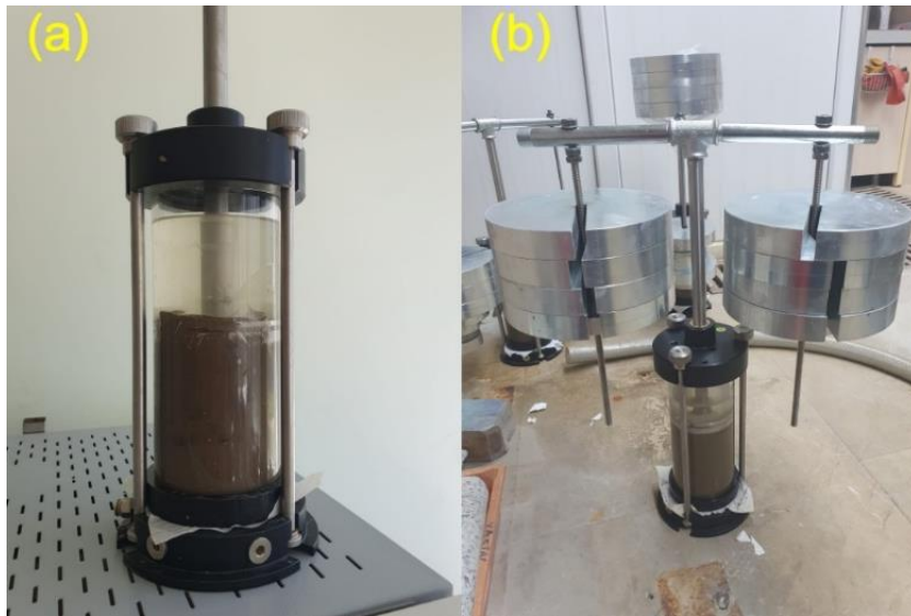
Şekil 31. 24 saatin ardından konsolidometrenin üst kapağının yerleştirilmesi (a) ve yükleme adımına geçilmesi (b)
