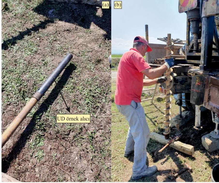
Şekil 12. Çalışma kapsamında özel olarak yaptırılan UD tip örnek alıcı (a) ve sondajın ilk 3 metresinin auger ile geçilmesi (b)
