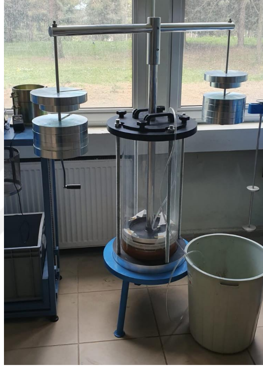
Şekil 26. alışmanın erken aşamasında üretilen büyük konsolidometre cihazı
