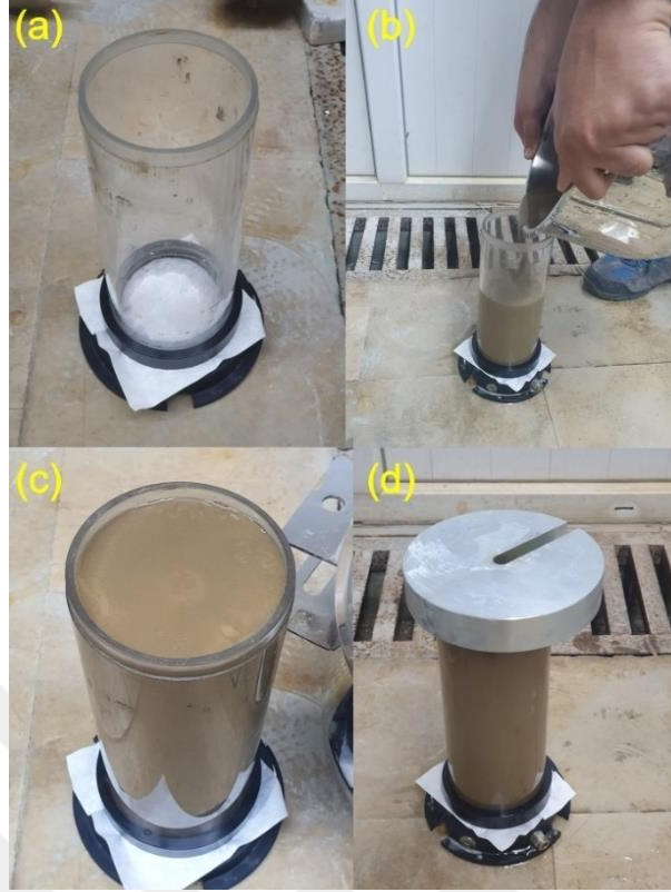
Şekil 30. Bulamacın konsolidometreye aktarılması. (a) Konsolidometrenin alt kısmının, örnek haznesinin ve filtre kağıdının görünümü; (b) Bulamacın örnek haznesine aktarılması; (c) Bulamaçla dolmuş olan örnek haznesinin görünümü; (d) Dinlenmeye bırakılan bulamaç ve konsolidometrenin görünümü
