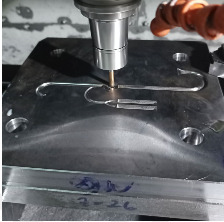
Şekil 7.11: Enjeksiyon tarafı plakanın işlenmesi.
