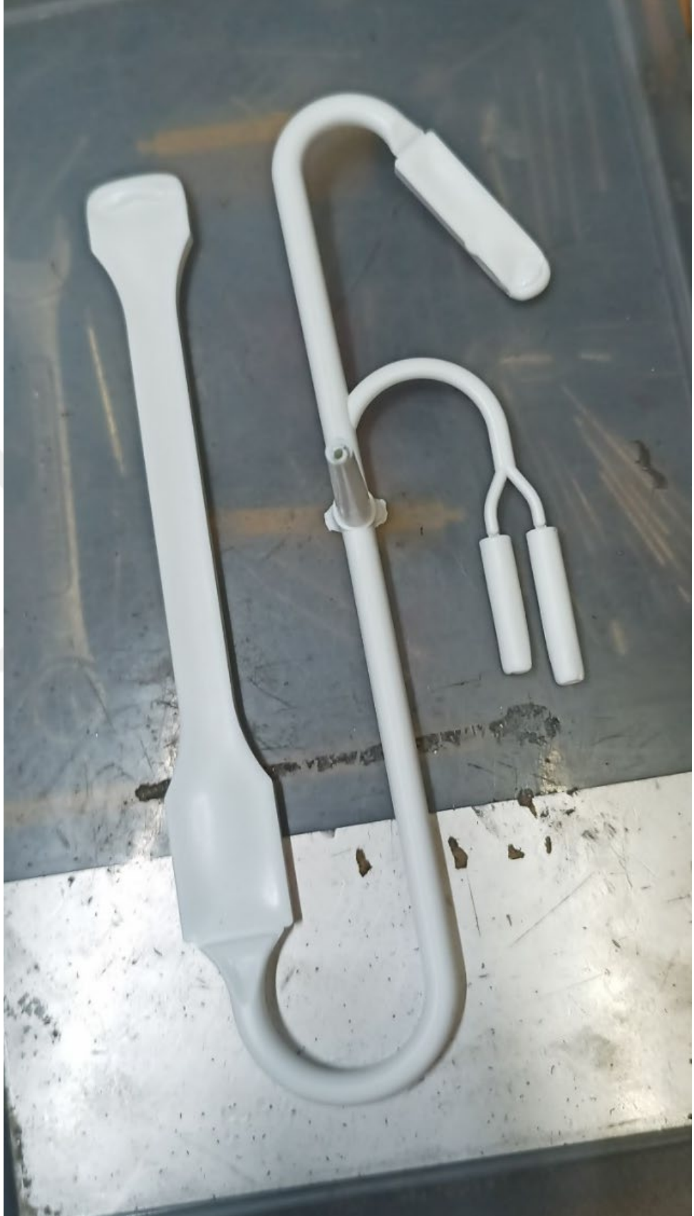
Şekil 8.1: Enjeksiyon makinasında ürünün eksik baskı alınmış hali
