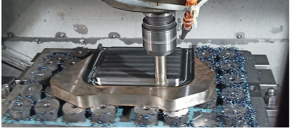
Şekil 7.5: Kütük parçadan arka plakanın işlenmesi.
