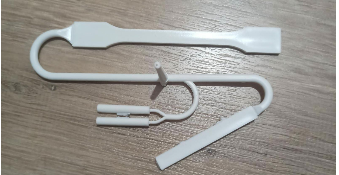
Şekil A.2: Ürünün çapaklanmaya başlama durumu.
