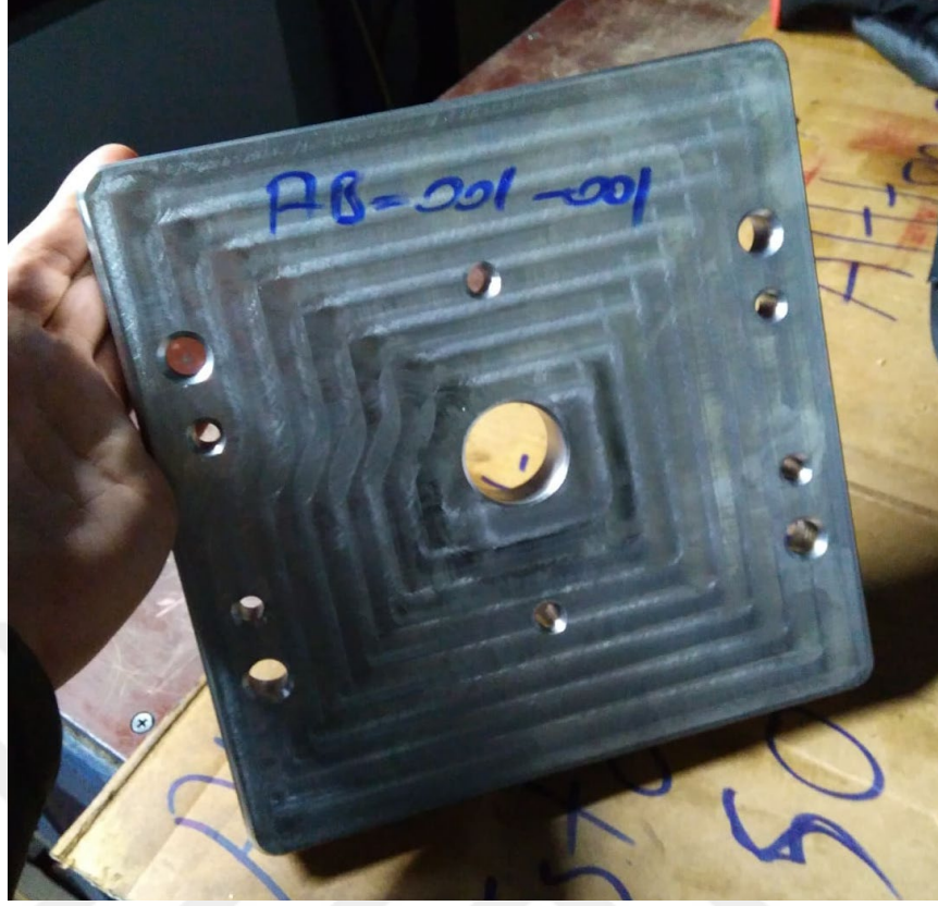
Şekil 7.6: İtici taraf arka plakasının CNC frezede işlenmesi sonrası görüntüsü
