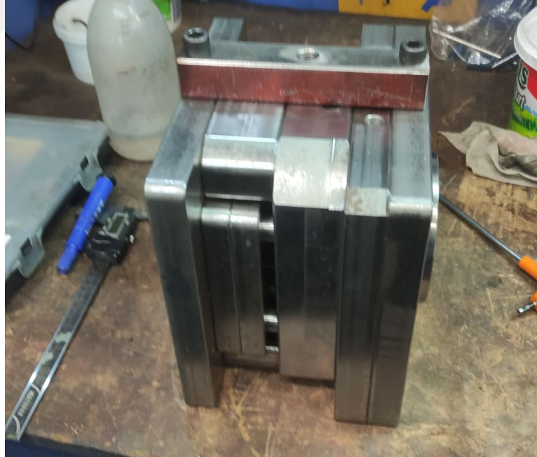
Şekil 7.12: Kalıbın montajlanmış son hali.
