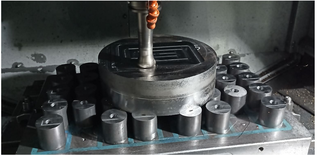
Şekil 7.3: Kütük malzemenin ölçülerine getirilmesi.
