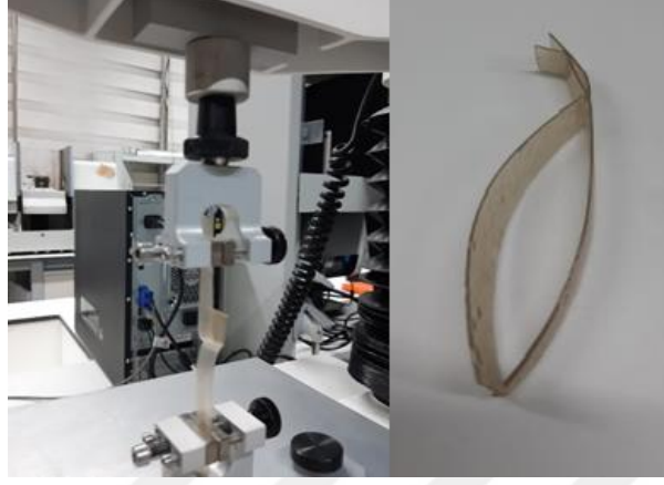
Şekil 3.14 : Isıl yapışma işlemi uygulanmış filme kopma kuvveti uygulanması ve yapıştırılmış film örneği.
