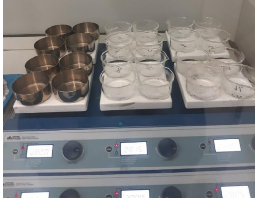
Şekil 3.16 : Kaplarda gıda benzerlerinin uçurulması.
