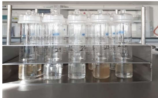
Şekil 3.15 : Migrasyon test tüplerindeki film örnekleri ve gıda benzerleri.
