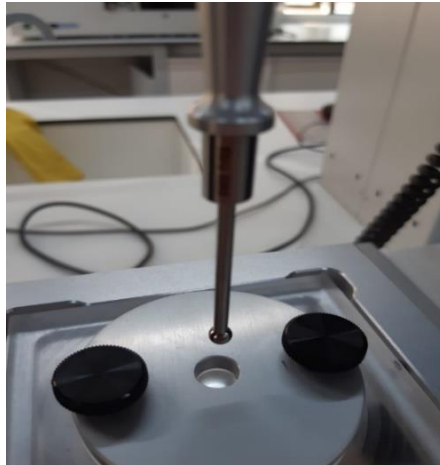
Şekil 3.9 : PK ve PU analizleri için proba yerleştirilmiş film örneği.
