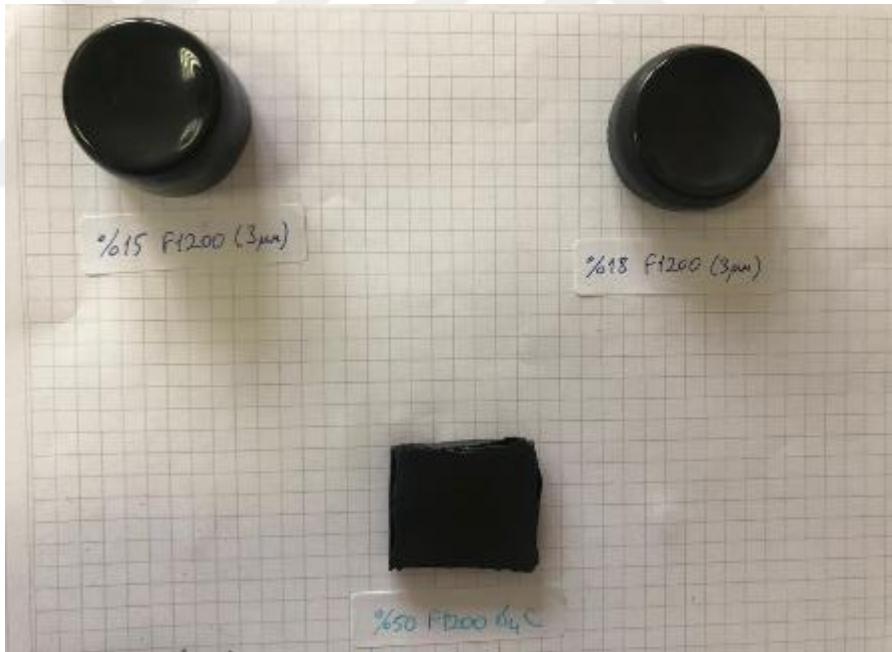
Şekil 3.6 : Kütlegece %15,%18 ve %50 B 4 C-3 tozu içeren kompozitler.
