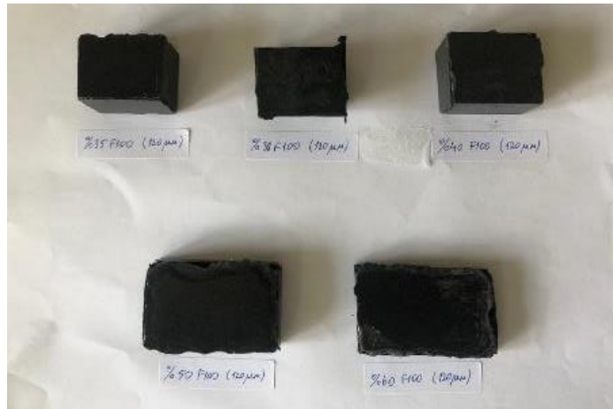
Şekil 3.4 : Kütlece %35,%38,%40,%50 ve %60 B 4 C içeren kompozitler.
