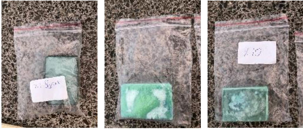
Şekil 3.14 : Soldan sağa sırasıyla %2, 7.5 ve 10 boraks katkısı içeren Boraks-PMMA kompozitleri.
