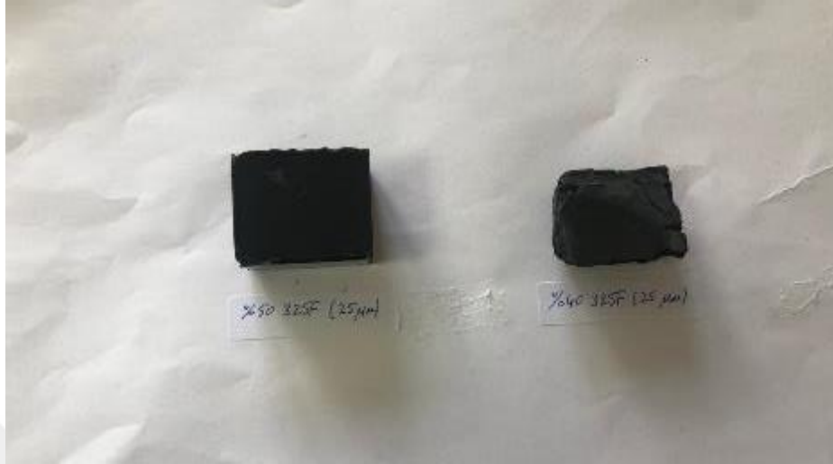
Şekil 3.5 : Kütlegece %40 ve %50 B 4 C -2 tozu içeren kompozitler.
