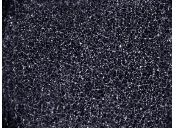
Şekil 4.26 : %50 B 4 C-2 tozu katkıli kompozitin stereomikroskop 30x görüntüsü.
