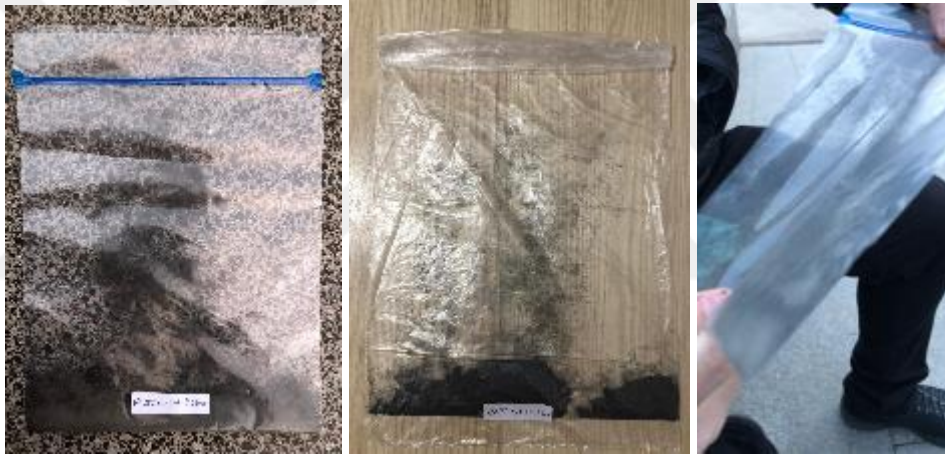
Şekil 3.15 : Soldan sağa sırasıyla B 4 C-2 ve B 4 C-3 tozlarını içeren poşet ve karıştırma işlemi resimleri.
