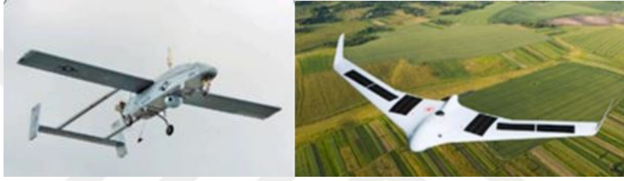
Şekil 2.1. Sabit kanatlı İHA türleri ( http-2 , http-3 )
