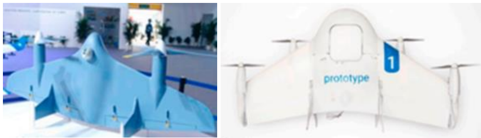
Şekil 2.2. Hibrit İHA'lar, VD200 uçan kanat (NavalDrones, 2020), Google X-wing ( http-4 )
