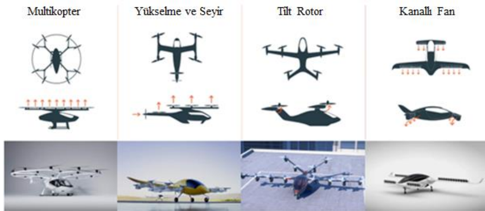
Şekil 3.3. En yaygın eVTOL mimari örnekleri (Nathen vd., 2021)
