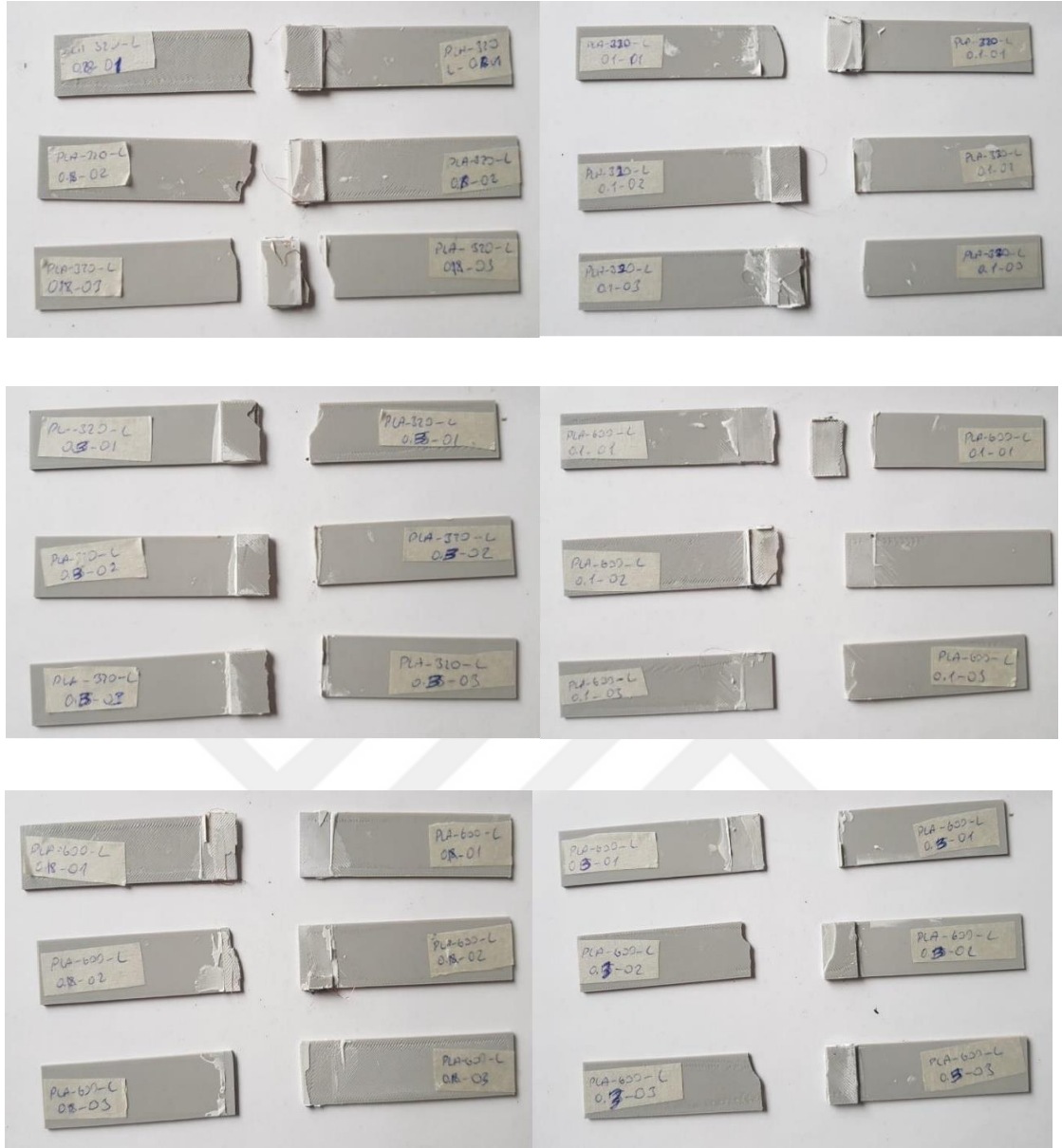
Şekil A.2 PLA-PLA 320 SiC-600 SiC Loctite Malzeme Çiftlerinin Kırılma Yüzey Görüntüsü
