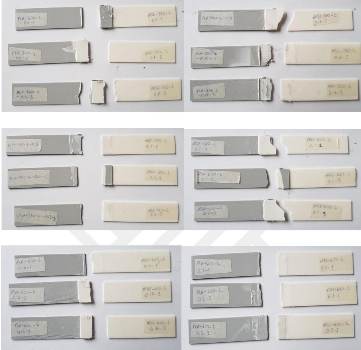
Şekil C.2 PLA-ABS 320 SiC-600 SiC Loctite Malzeme Çiftlerinin Kırılma Yüzey Görüntüsü
