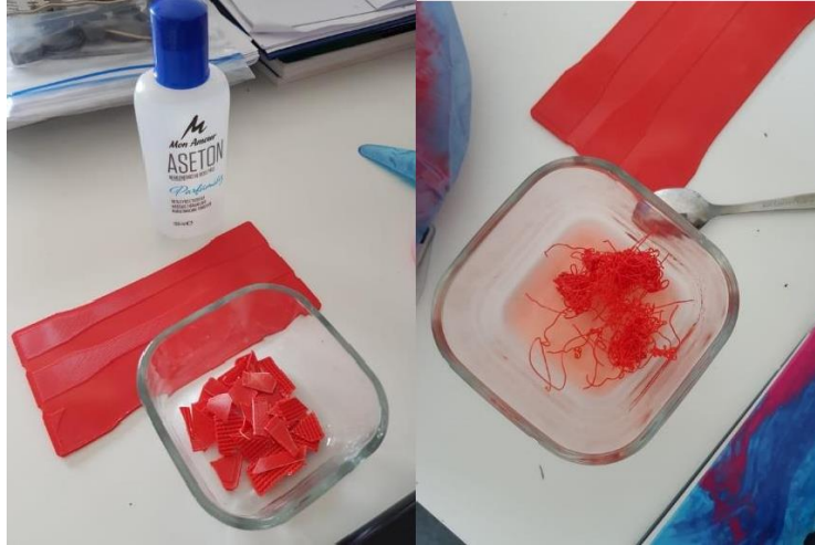
Şekil 4.6 ABS filamenti ile çözelti hazırlama
