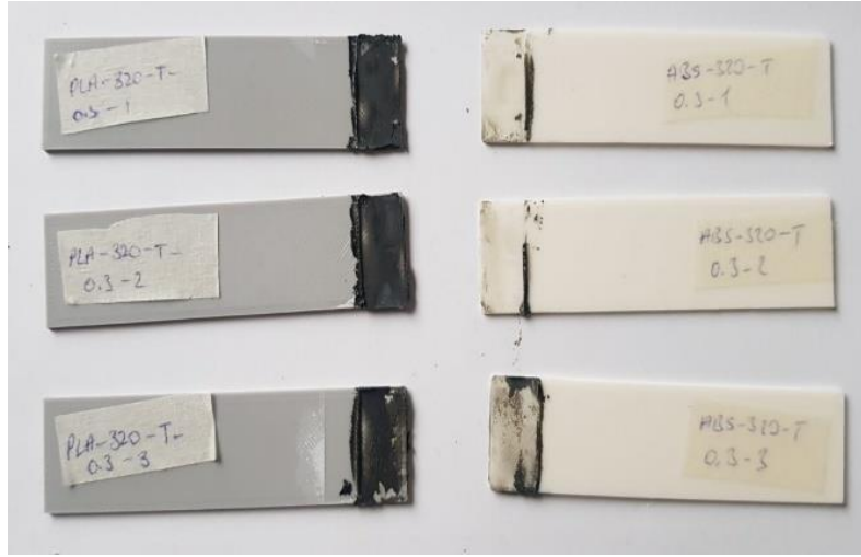
Şekil 5.3 PLA-ABS Teroson PU 9225 ile bağlantı yapılmış çiftler (320 SiC)
