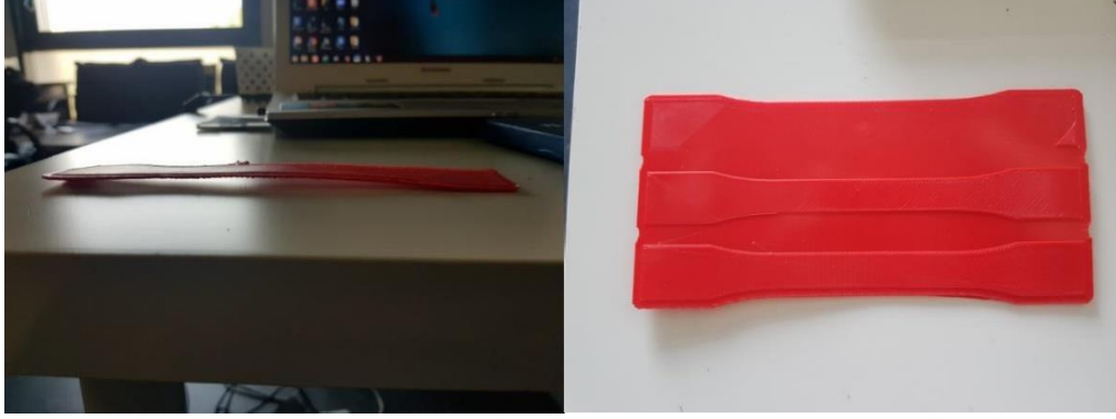
Şekil 4.5 ABS numunelerde karşılaşılan kalkma eğilimi sorunları
