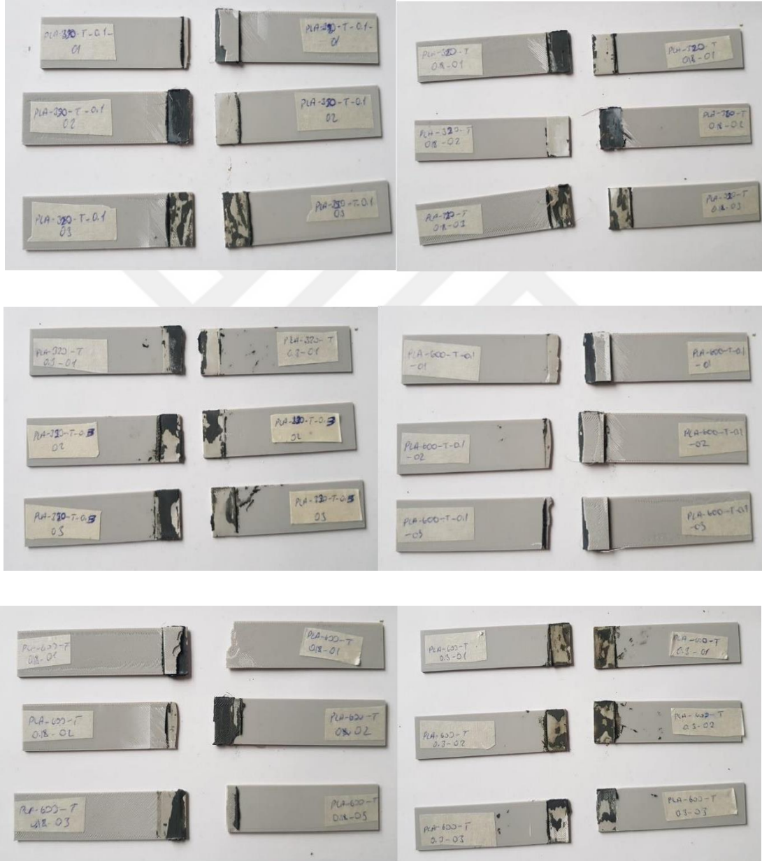
Şekil A.1 PLA-PLA 320 SiC-600 SiC Teroson Malzeme Çiftlerinin Kırılma Yüzey Görüntüsü
