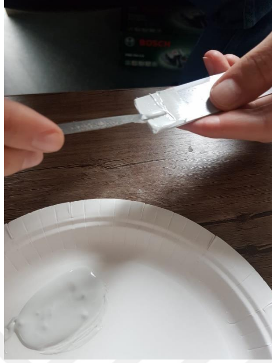
Şekil 4.16 Spatula yardımı ile yapıştırıcının sürülmesi
