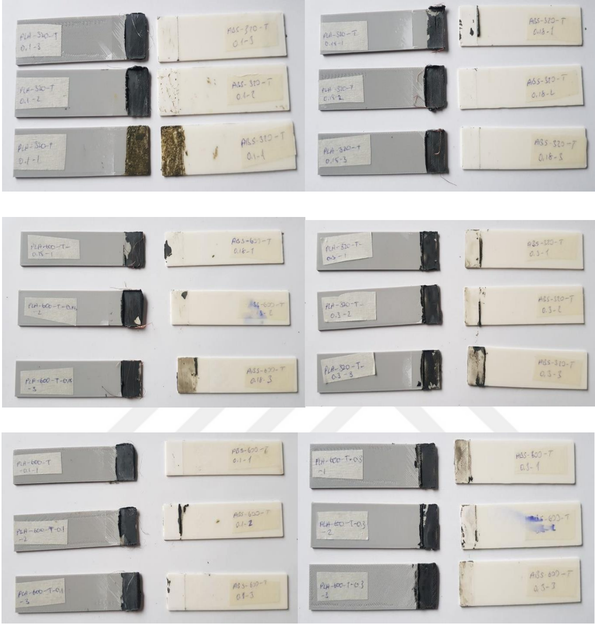
Şekil C.1 PLA-ABS 320 SiC-600 SiC Teroson Malzeme Çiftlerinin Kırılma Yüzey Görüntüsü
