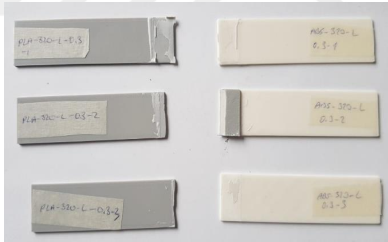
Şekil 5.4 PLA-ABS 320 SiC zımpara ve Loctite EA 9492 ile bağlantı yapılmış çiftler
