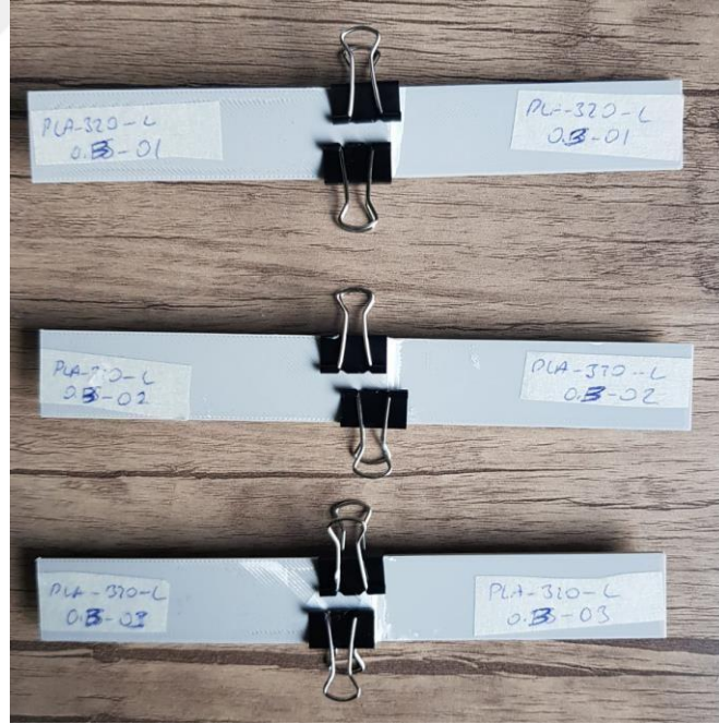
Şekil 4.17 Yapıştırma işlemi yapılmış bağlantılar
