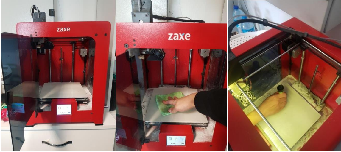
Şekil 4.3 Yazıcı tablasının hazırlanması
