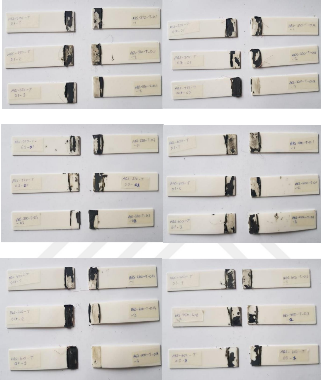
Şekil B.1 ABS-ABS 320 SiC-600 SiC Teroson Malzeme Çiftlerinin Kırılma Yüzey Görüntüsü
