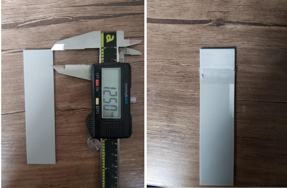
Şekil 4.13 Numunelerin ölçülüp işaretlenme aşaması
