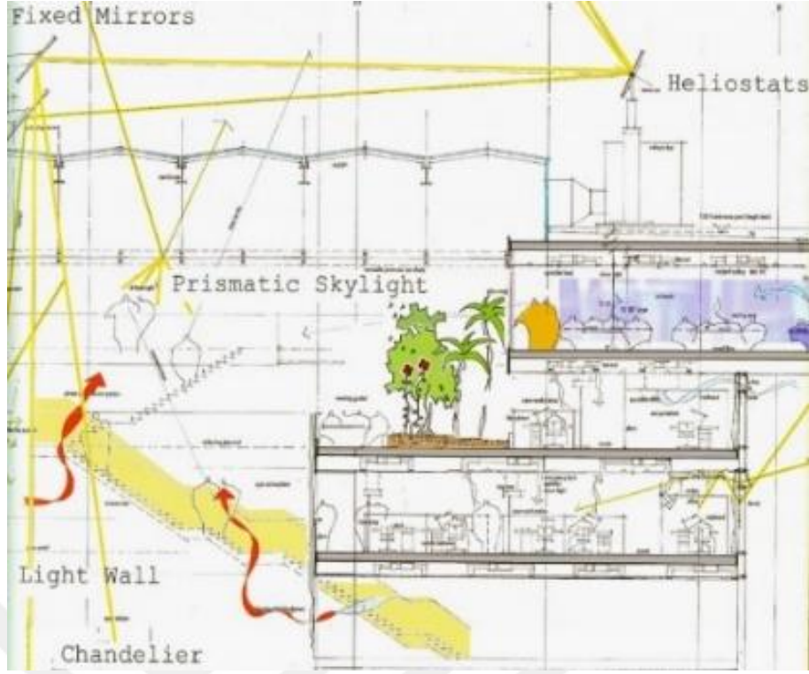
Şekil 4.43. Atriumda Yer Alan Güneş Yönlendirme Sisteminin Şeması
