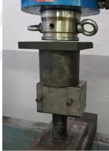
Şekil 5.17. FDM numunesinin sıcak iş takım çeliğine aktarılması
