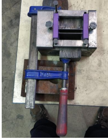
Şekil 5.12. Dikey ayırıcılı kalıba ayırıcıların yerleşimi
