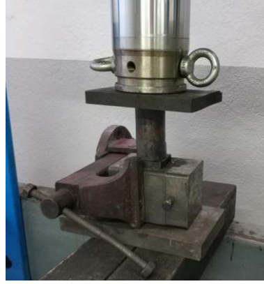
Şekil 5.16. Dikey ayırıcılı kalıba ön basınç uygulanması
