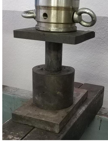
Şekil 5.18. FDM numunesine sıcak iş takım çeliğinde ön basınç uygulanması
