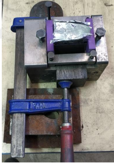
Şekil 5.13. Dikey ayırıcılı kalıba tozların doldurulması
