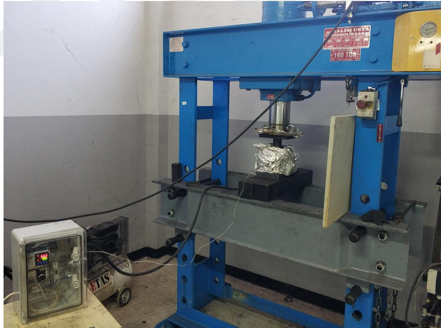
Şekil 5.19. FDM numunesinin basınç altında sinterlenmesi
