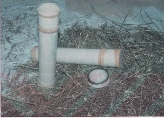
Şekil 3. 1 Laboratuvar koşullarında araştırmanın yürütüldüğü PVC silo kapları.
