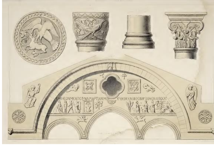
Şekil 3.7. Trabzon Ayasofya Camii güney cephe giriş portalı süsleme özellikleri (Texier and Pullan, Byzantine Architecture)
