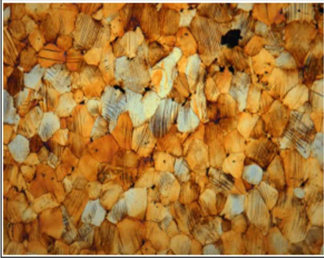
Şekil 2.3. Çalışma sertleşmesi sonrası yüksek manganlı çelik mikro yapısı [4].
